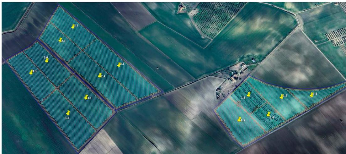
Nel complesso i 13 macromoduli o sottocampi saranno composti di 67.564 **moduli fotovoltaici** con potenza di picco di 695 W ciascuno, montati su strutture a tracker con inseguitori E-O connessi tra di loro in stringhe. Le stringhe saranno collegate a 243 inverter (circa 10 stringhe per ogni inverter) per una potenza complessiva di 46,96 MW.
