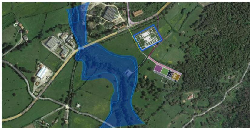
Figura 35 – Inquadramento nuova configurazione SSEU e opere comuni in relazione alle aree a pericolo idraulico Hi4/Hi3 e pericolo geomorfologico Hg4/Hg3 Rappresentate nell'elaborato grafico C20042S05-VA.PL-01.1-01
