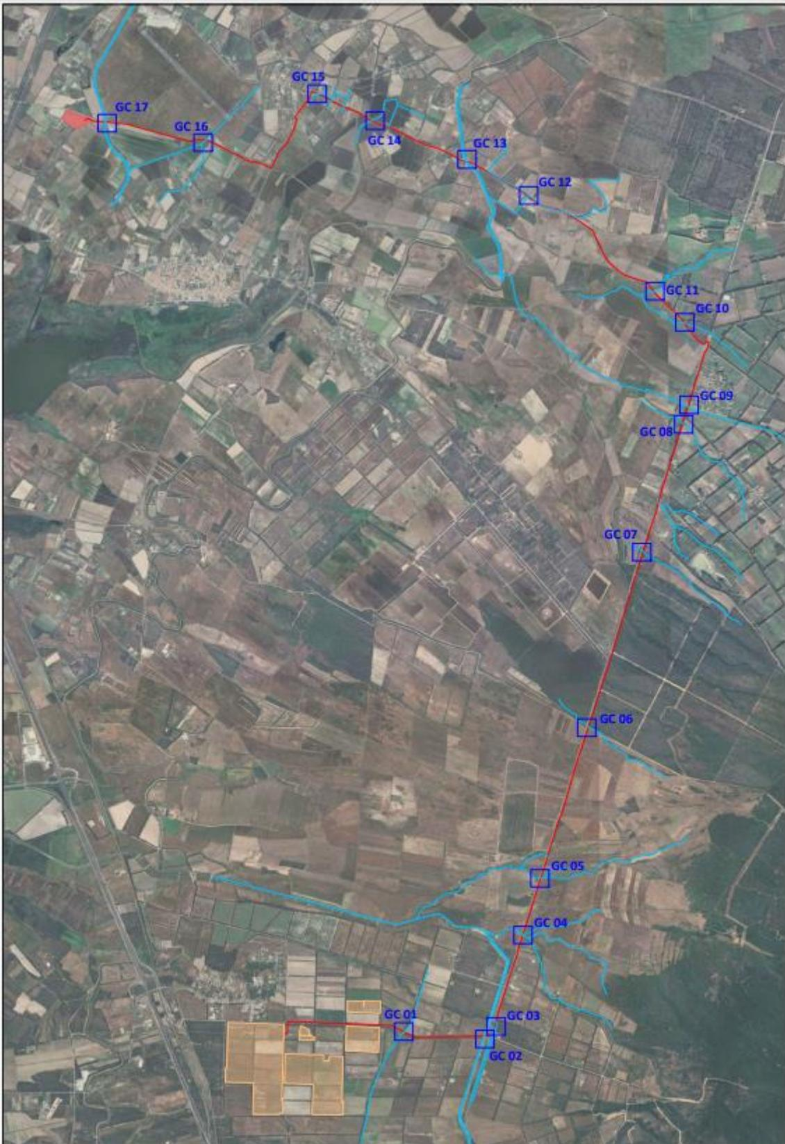
Figura 22 - Percorso cavidotto e individuazione intersezioni con corpi idrici individuati da IGM
