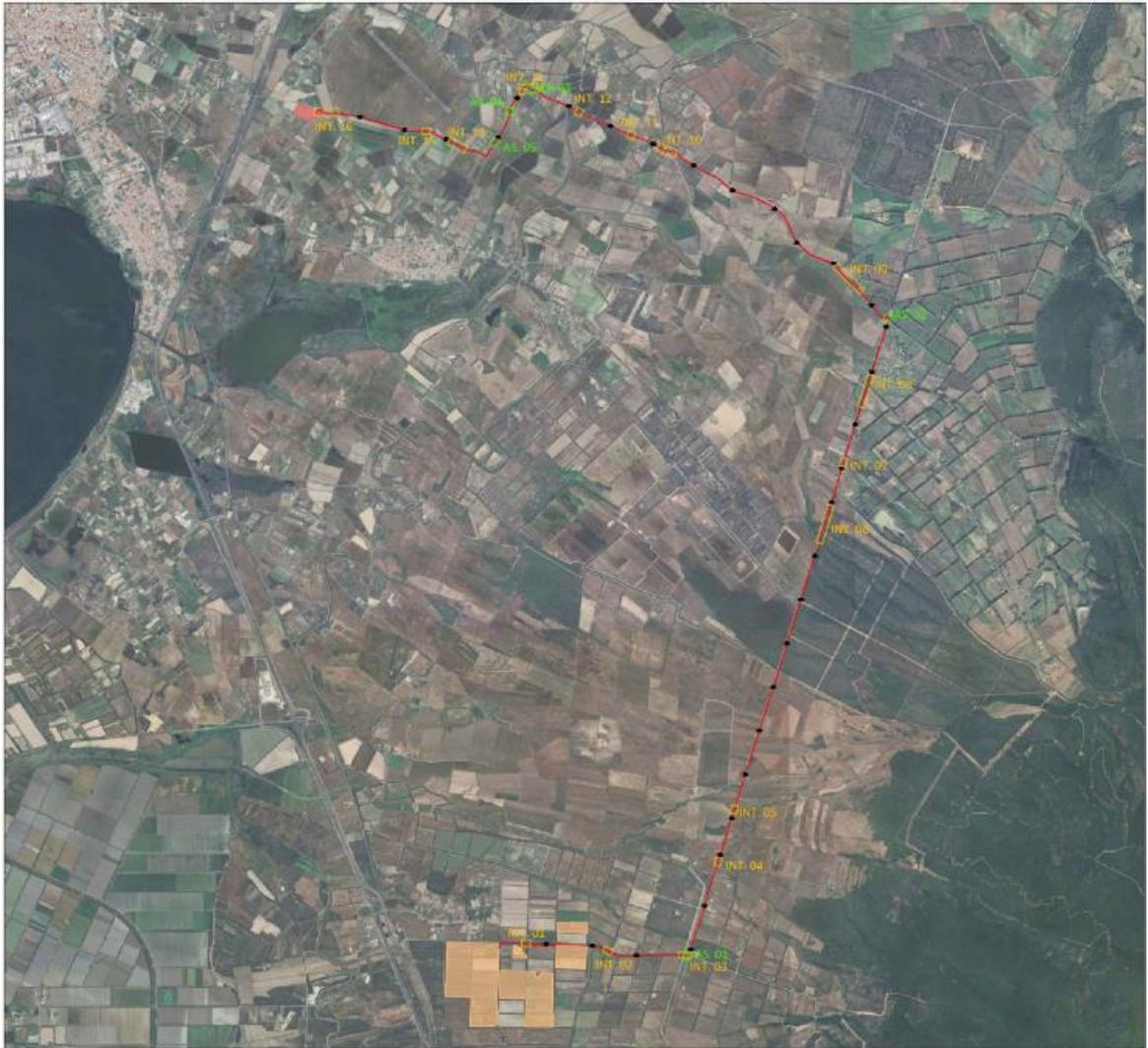
Figura 13 - Percorso di connessione su base ortofoto con individuazione interferenze, buche giunti e punti TOC
