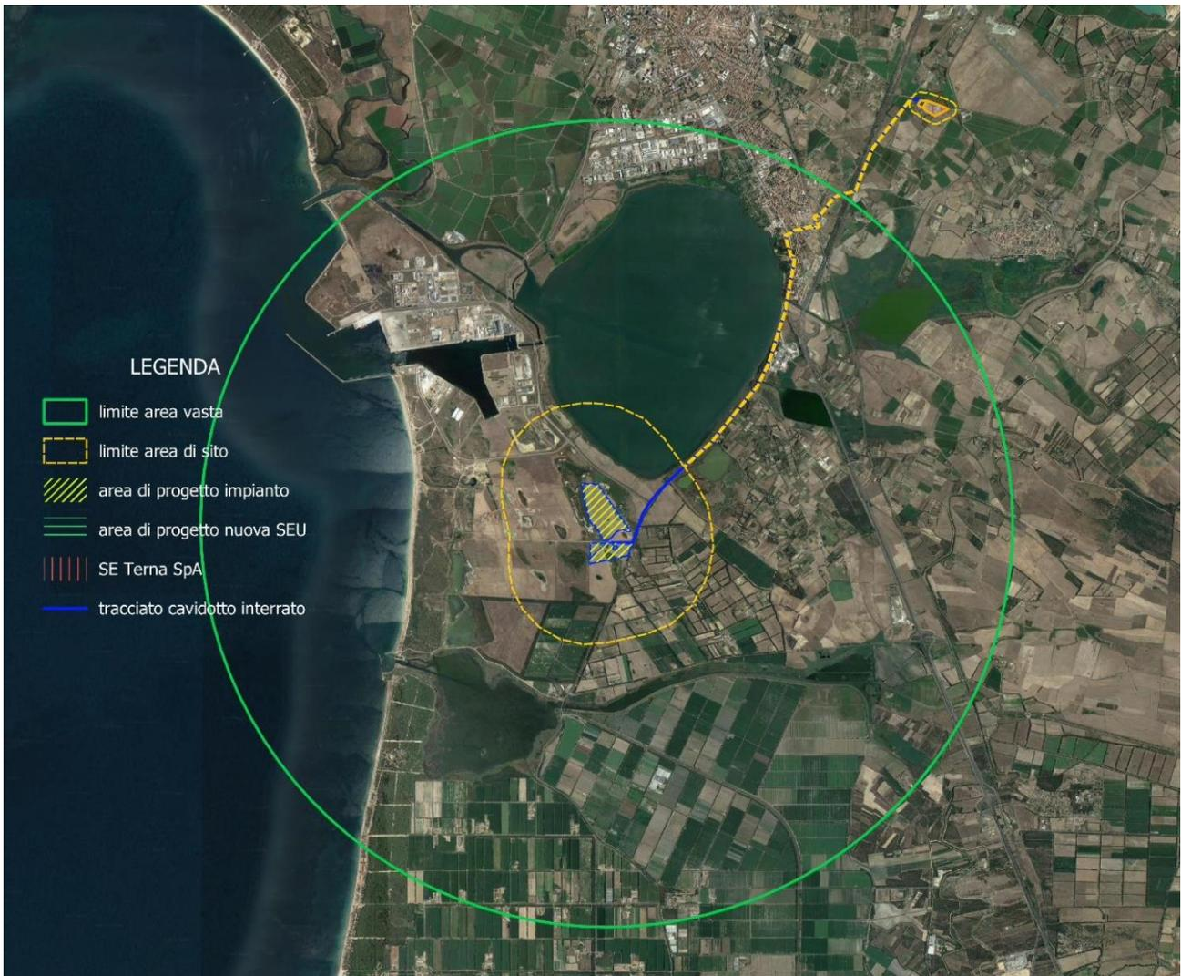
*Progetto di un impianto fotovoltaico della potenza pari a 27,07 MW e delle relative opere di connessione alla RTN, da realizzarsi nel Comune di Santa Giusta (OR), in località "Cirras"*
