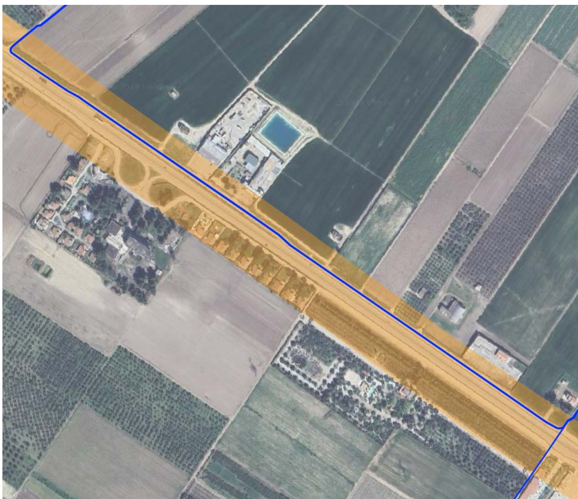
Ortofoto con l’indicazione del cavidotto MT in progetto (in blu) e dell’area tutelata e rappresentata dal “Regio Tratturo Foggia Ofanto” (in arancio) quasi interamente interessata dalla SS16 Adriatica e dalla viabilità complanare esistente ai lati della strada statale.
