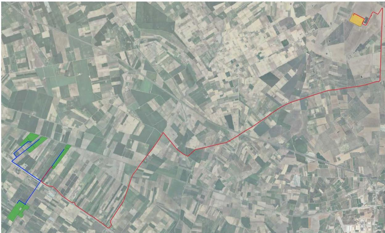
*Ortofoto con l'indicazione delle aree che costituiscono l'impianto agrovoltaico in progetto (in verde), dei cavidotti MT di collegamento tra le aree (in blu), del cavidotto AT di collegamento tra la sottostazione di trasformazione 30/36 kV, la cabina di consegna 36 kV e la SSE 380/150/36 kV di TERNA S.p.A. in costruzione.*
