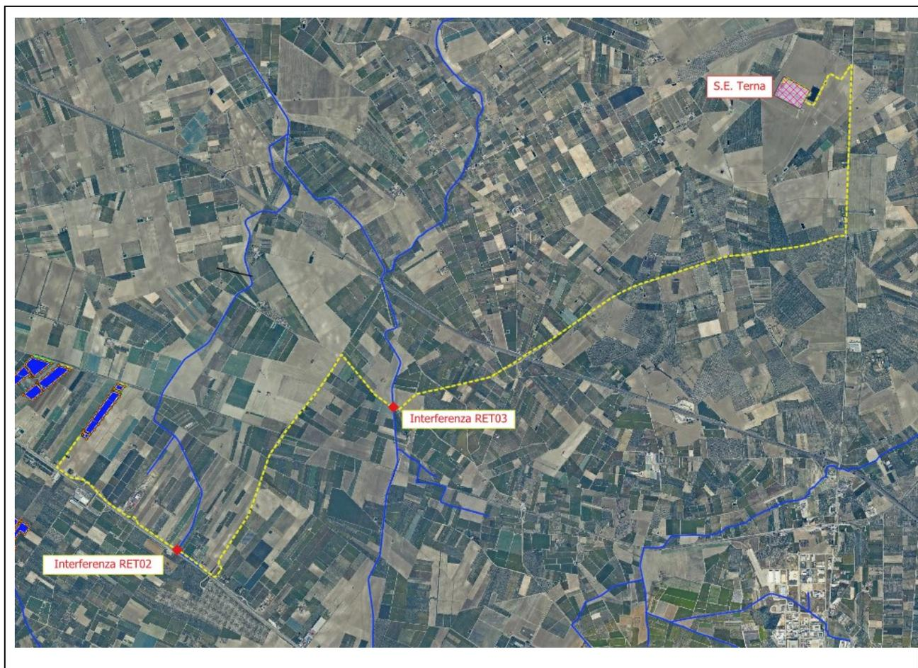
Figura 7 - Cavidotto di vettoriamento e interferenze con reticolo idrografico
