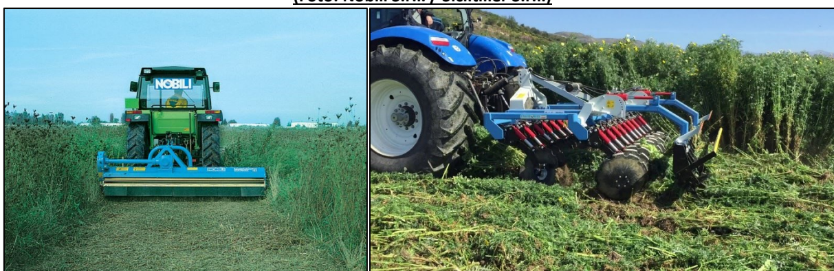
Fig. 6.8: Trinciatura del manto erboso, utilizzando la trincia o direttamente con il frangizolle a dischi (Foto: Nobili S.r.l. / Siciltiller S.r.l.)
