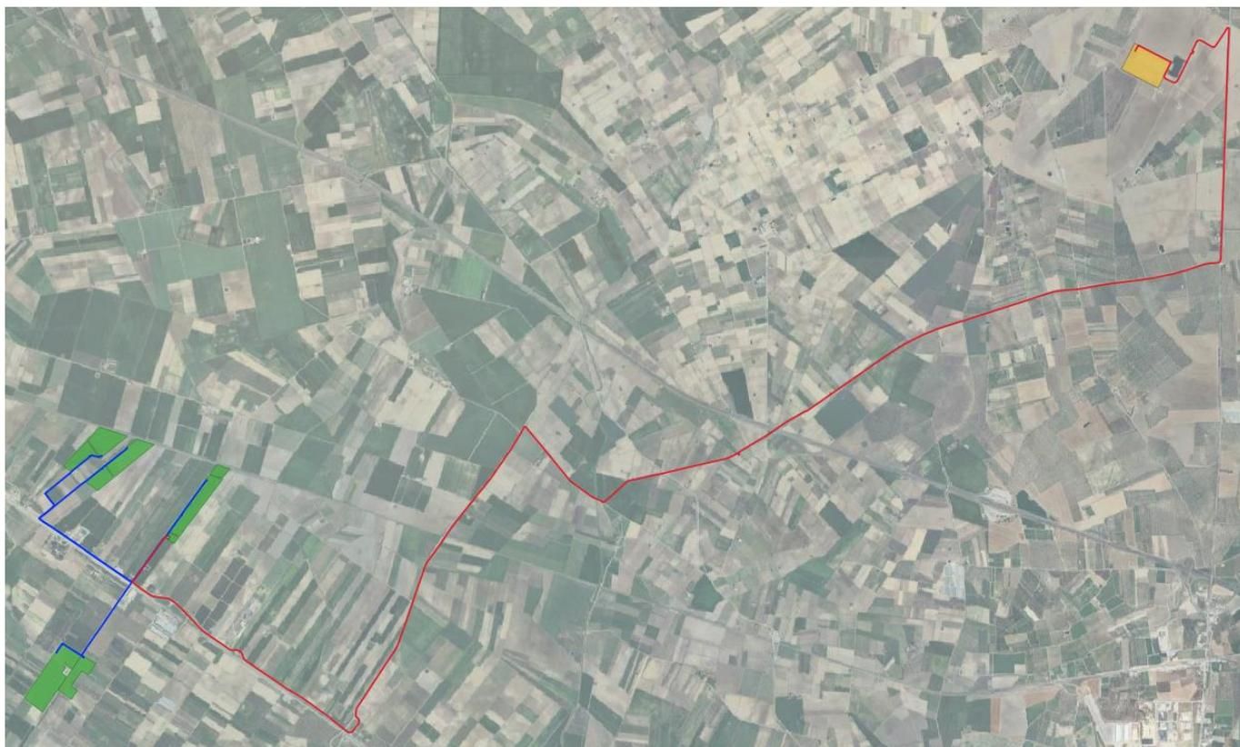
Figura 1.2. – Ortofoto con l’indicazione delle aree che costituiscono l’impianto agrovoltaico in progetto (in verde), dei cavidotti MT di collegamento tra le aree (in blu), del cavidotto AT di collegamento tra la sottostazione di trasformazione 30/36 kV, la cabina di consegna 36 kV e la SSE 380/150/36 kV di TERNA S.p.A. in costruzione.
