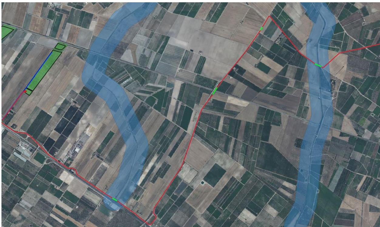
Figura 5.8a – Ortofoto con l’indicazione del cavidotto AT interrato (in rosso), che collega la sottostazione di trasformazione 30/36 kV alla cabina di consegna 36 kV, che interferisce con il canale “Pedicletta di Zezza” e con il canale “Marana Castello”. In verde sono indicati i tratti di cavidotto da realizzare in T.O.C.
