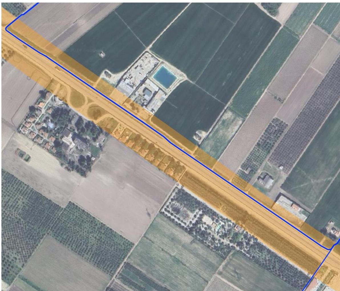
Figura 5.1. Ortofoto con l’indicazione del cavidotto MT in progetto (in blu) e dell’area tutelata e rappresentata dal “Regio Tratturo Foggia Ofanto” (in arancio) quasi interamente interessata dalla SS16 Adriatica e dalla viabilità complanare esistente ai lati della strada statale.
