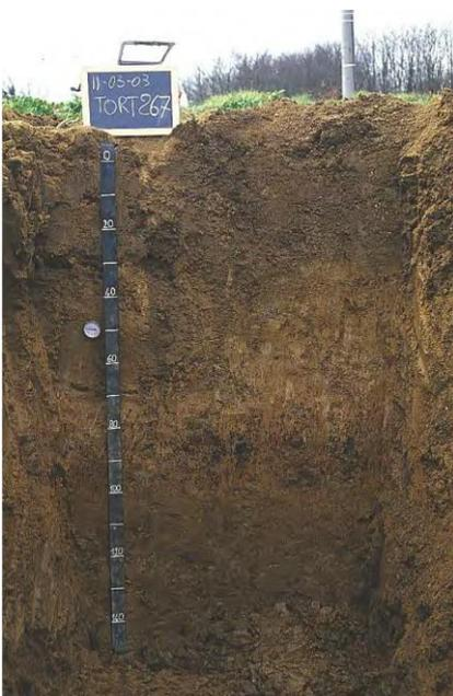
0-30 cm: orizzonte compreso tra la superficie e la profondità delle arature (corrisponde al topsoil). Il colore scuro identifica una presenza di sostanza organica maggiore rispetto alla parte sottostante.
