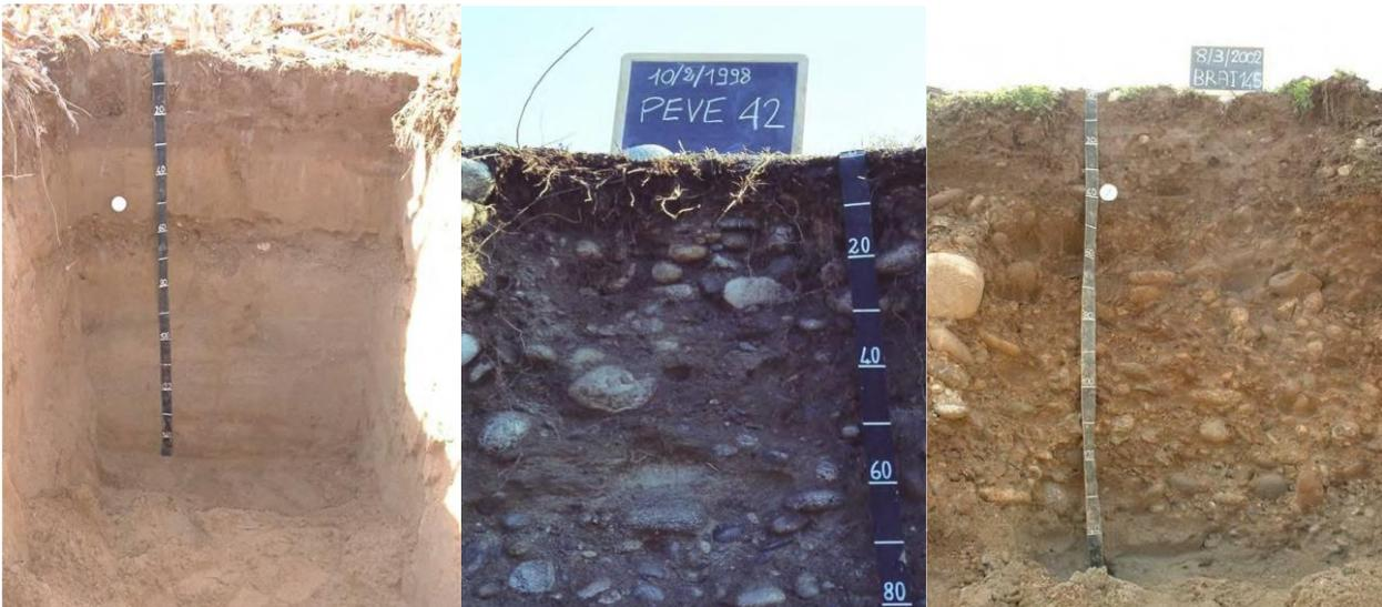
Figura 4.2. – Esempi di scavi per la rilevazione del profilo pedologico (Fonte Allegato “A” IPLA Piemonte).
