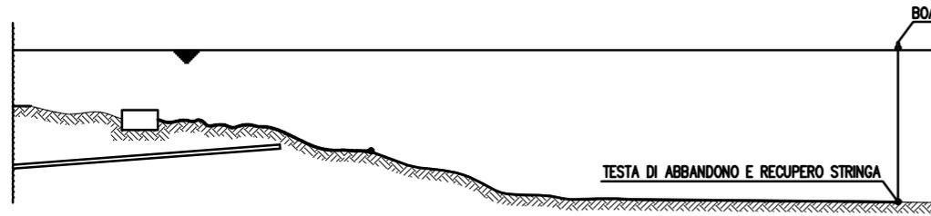
**FASE 6** Una volta eseguito lo sfondamento della TOC ( che può essere effettuato anche nelle fasi precedenti ) si sostituisce la seconda fresa con la fresa di trivellazione finale agganciandola alla testa di tiro della condotta.
