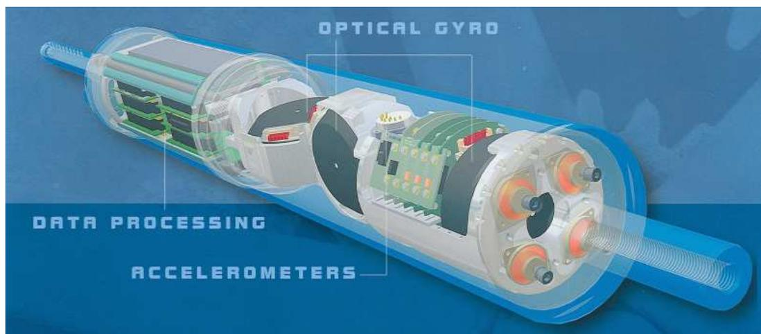
**Figura 3.5: Rappresentazione schematica del giroscopio**
