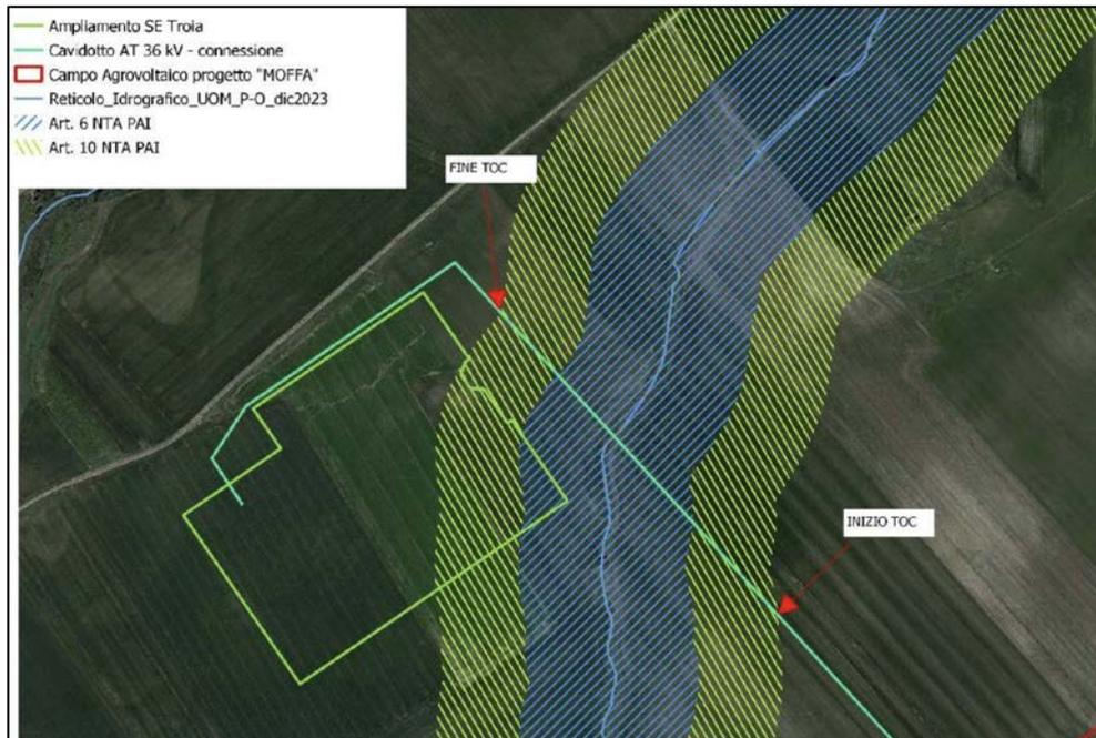
Figura 31 Rappresentazione punto di inizio e fine del T.O.C. del cavidotto
