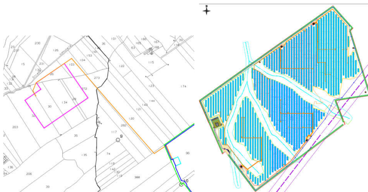
Figura 27: Planimetria cavidotto esterno ed interno all'impianto
