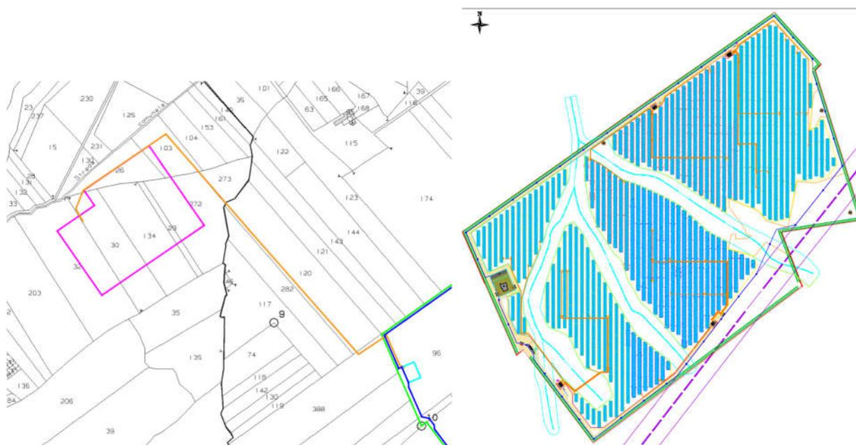
**Figura 7: Planimetria cavidotto esterno ed interno all'impianto**
