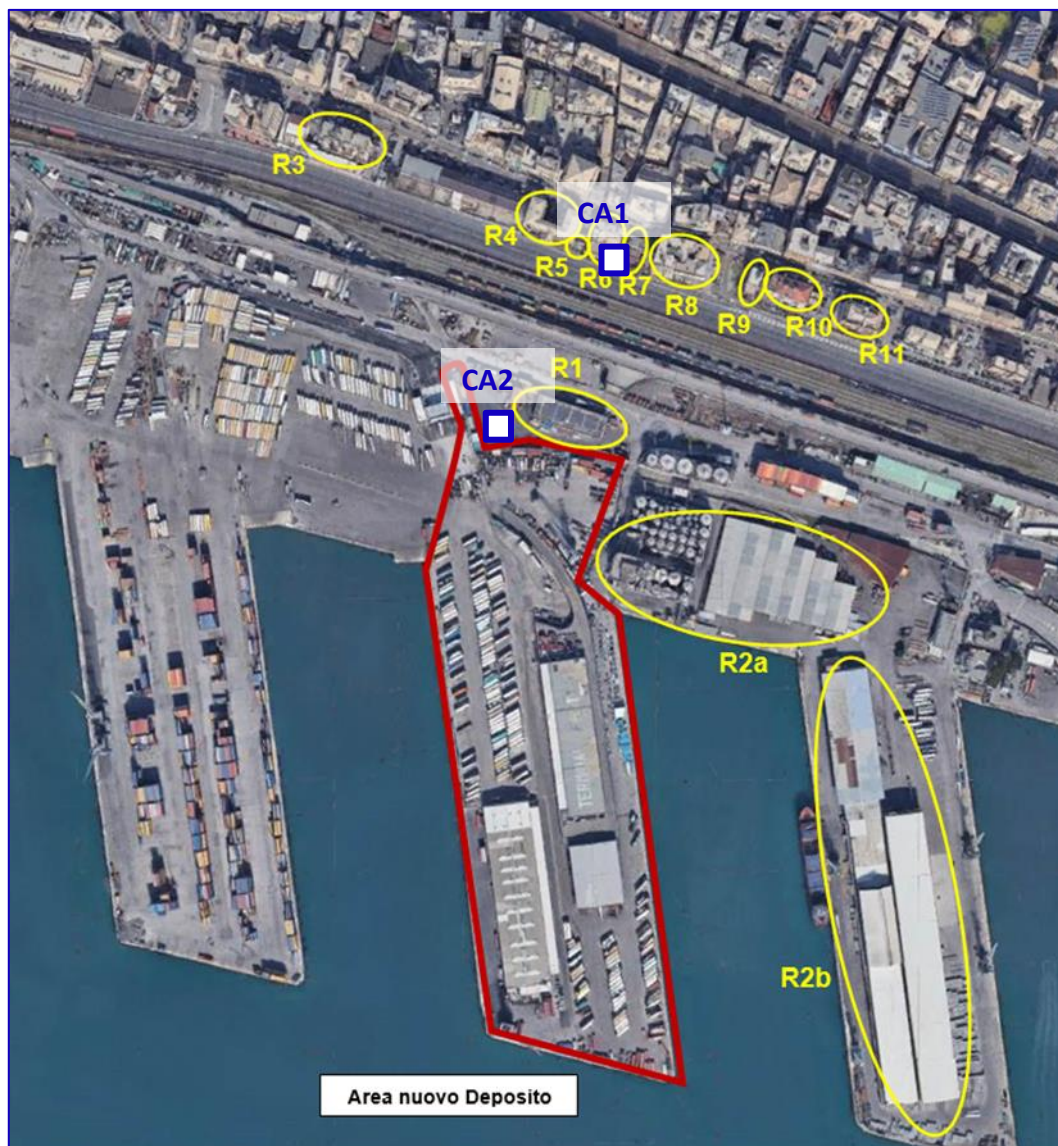
Figura 3 - Ubicazione della postazione di monitoraggio durante la fase di cantiere
