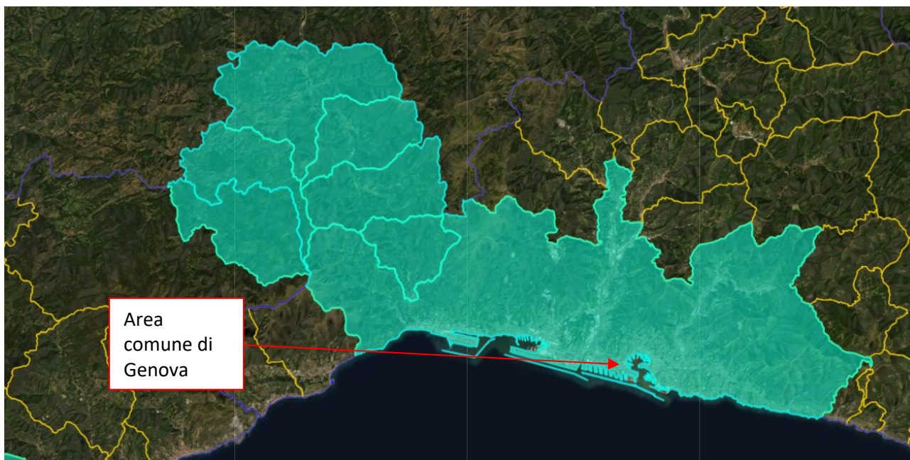
Figura 31 :Stralcio del Comune di Genova: area interessata da Liquefazione ai sensi della D.G.R n 535 del 18.06.2021.
