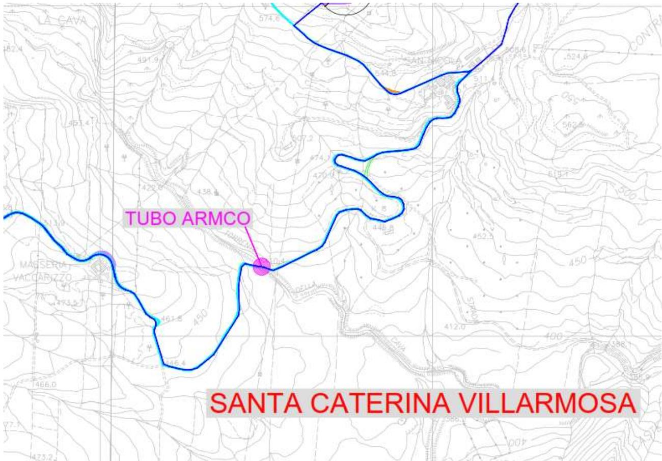
Figura 15 - posizione del tubo ARMCO su stralcio CTR
