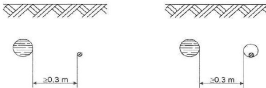
Figura 115 - disegno esemplificativo di parallelismo tra due tubazioni
