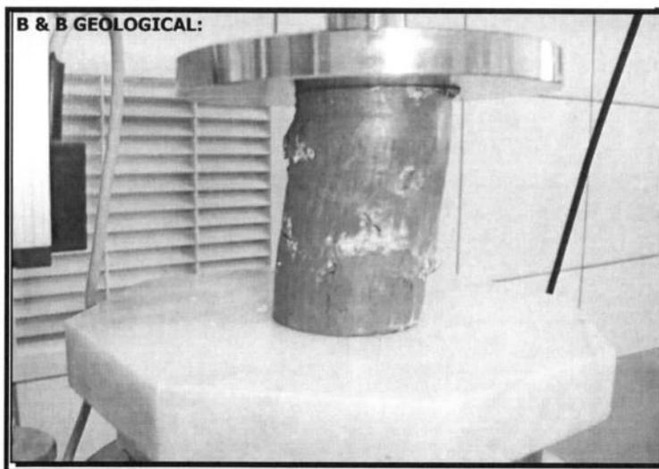
**NOTE:** Rottura al taglio netto lungo una superficie con inclinazione di circa 40° rispetto alla verticale.
