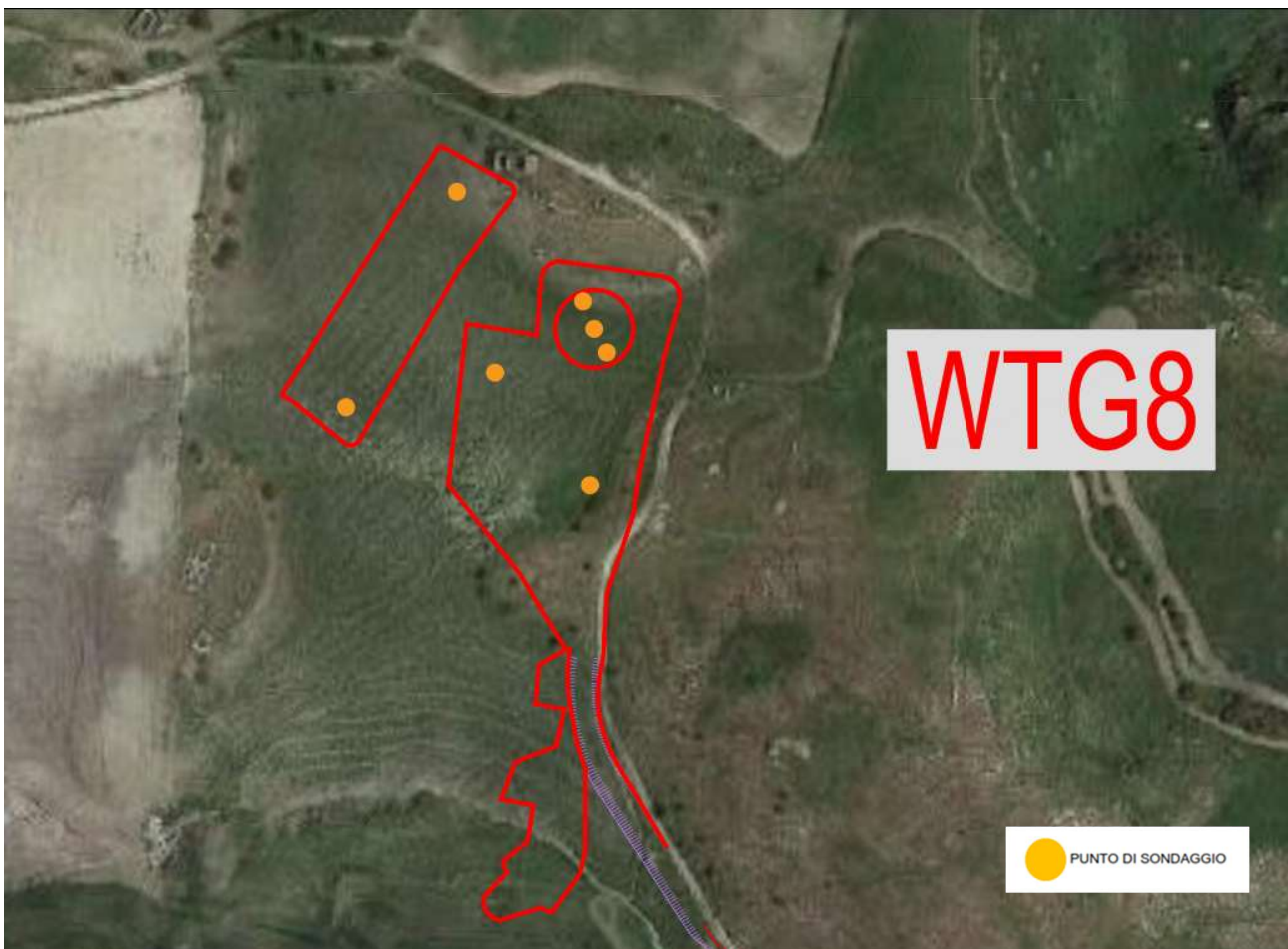
Figura 6 – Sondaggi previsti per le fondazioni e la piazzola della WTG 8
