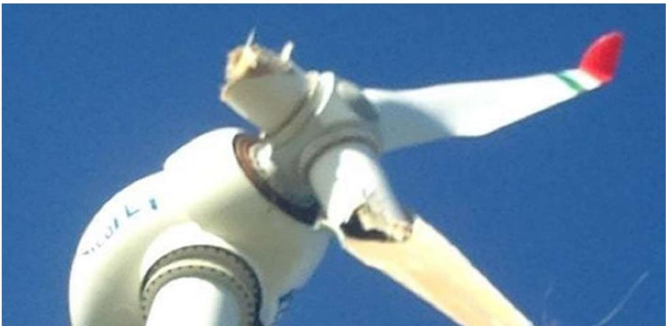
*Figura 5- Esempio di rottura alla radice*
