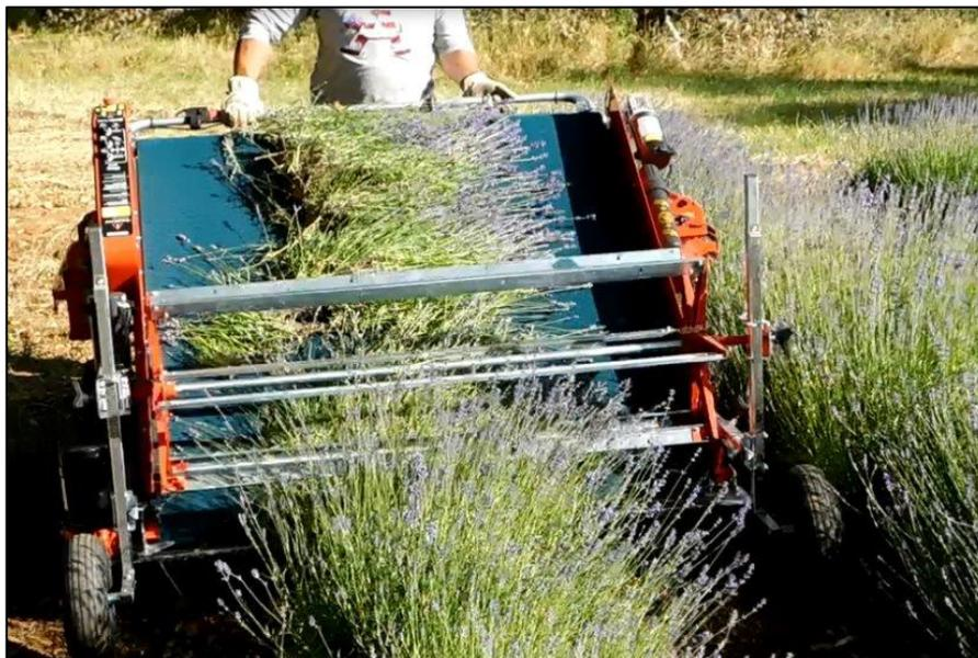
Figura 30: Macchinario per la raccolta delle piante aromatiche. In figura è mostrata la raccolta della lavanda tramite taglio e carico, ma la stessa operazione viene effettuata con le piante di rosmarino.
