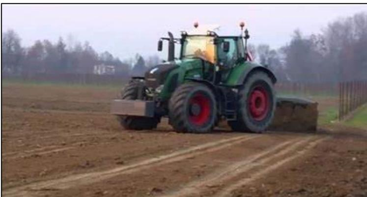
Il terreno sarà livellato, lavorandolo tramite macchina livellatrice, al fine di predisporre il fondo alla cantierabilità per la realizzazione dell'impianto.
