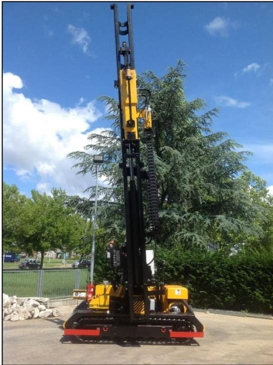
Figura 16: Macchina battipalo per l'infissione dei pali per i tracker.
