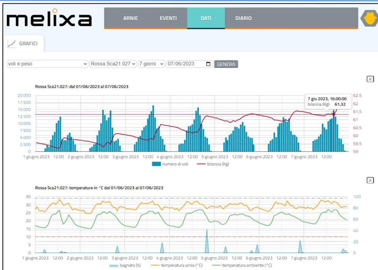
Figura 33: Schermata del sistema Melixa che mostra ora per ora la variazione di: numero di voli, peso dell'arnia, temperatura arnia, temperatura ambiente, bagnato – Parametri estrapolati da una delle arnie inserite nel contesto agrivoltaico di un impianto gestito da Le Greenhouse
