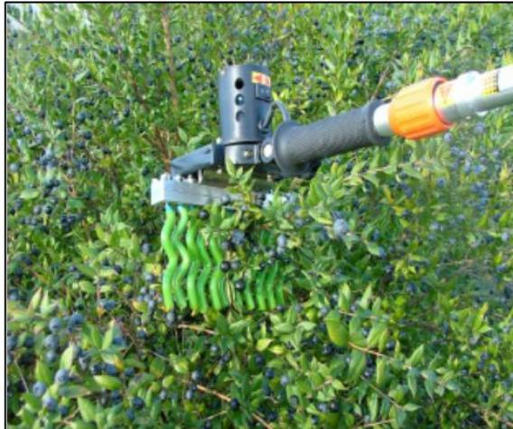
*Figura 27: Macchina agevolatrice (pettinatrice) Pick Machine, dal sito “La meccanizzazione della raccolta del mirto Paschino et al., Università di Sassari, Dipartimento di Ingegneria del Territorio, Sezione Meccanizzazione ed Impiantistica”. Si evidenziano le onduline in titanio rivestite di silicone verde per migliorare la raccolta.*
