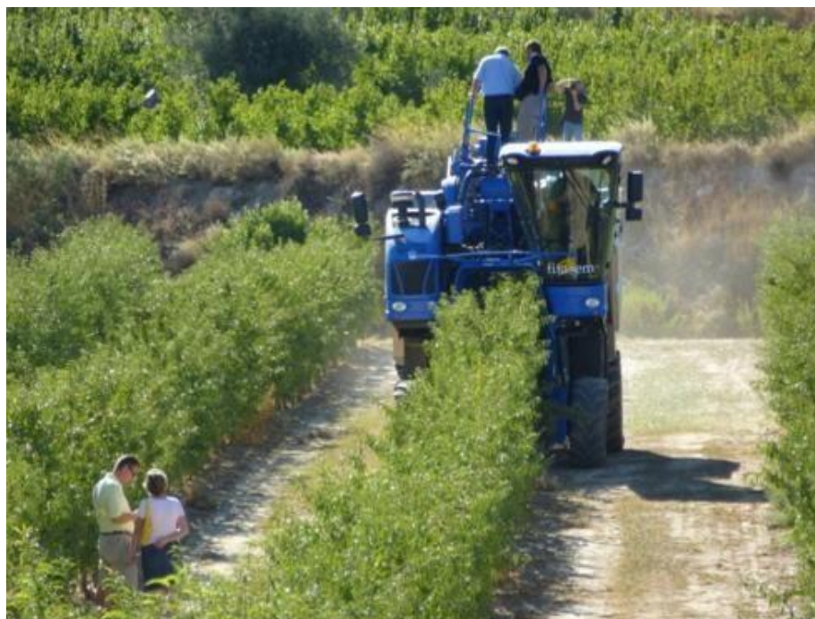
Foto 5 - Macchina scavallatrice durante le operazioni di raccolta in mandorleto superintensivo a siepone
