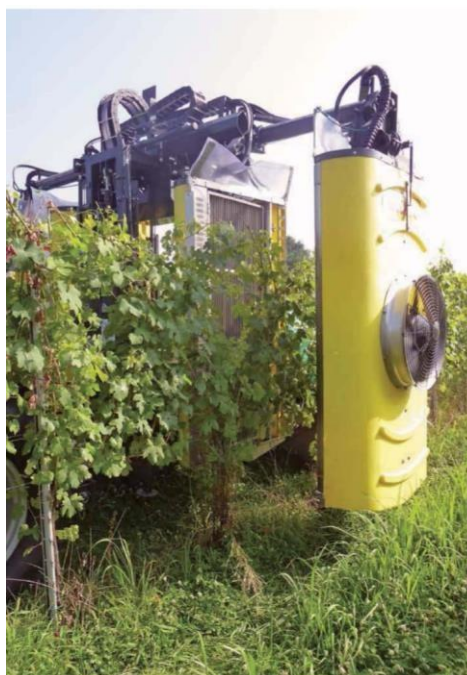
Foto 4 - pompa irroratrice a polverizzazione pneumatica con diffusore anti-deriva
