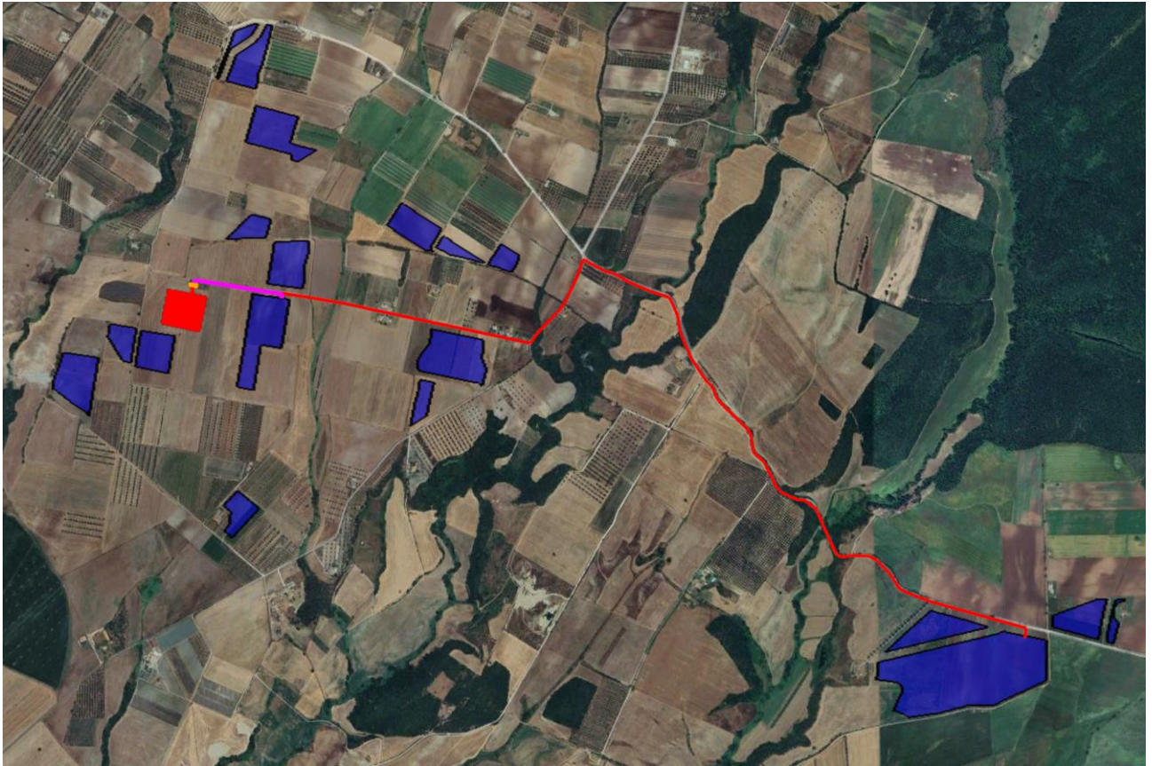
Fig. 5– Tracciato cavidotto MT verso SE
