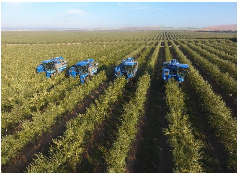
*Figura 20 - Esempio attività di raccolta con scavallatrici*
