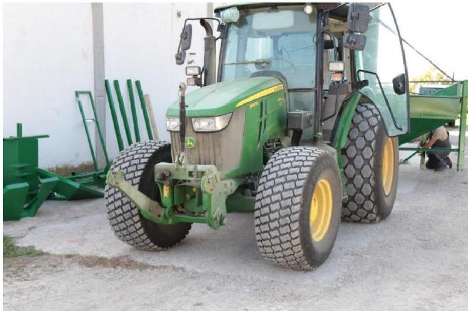
*Figura 22 - Trattatrice equipaggiata con gomme anti-compattamento atte a non distruggere le caratteristiche fisiche del suolo*
