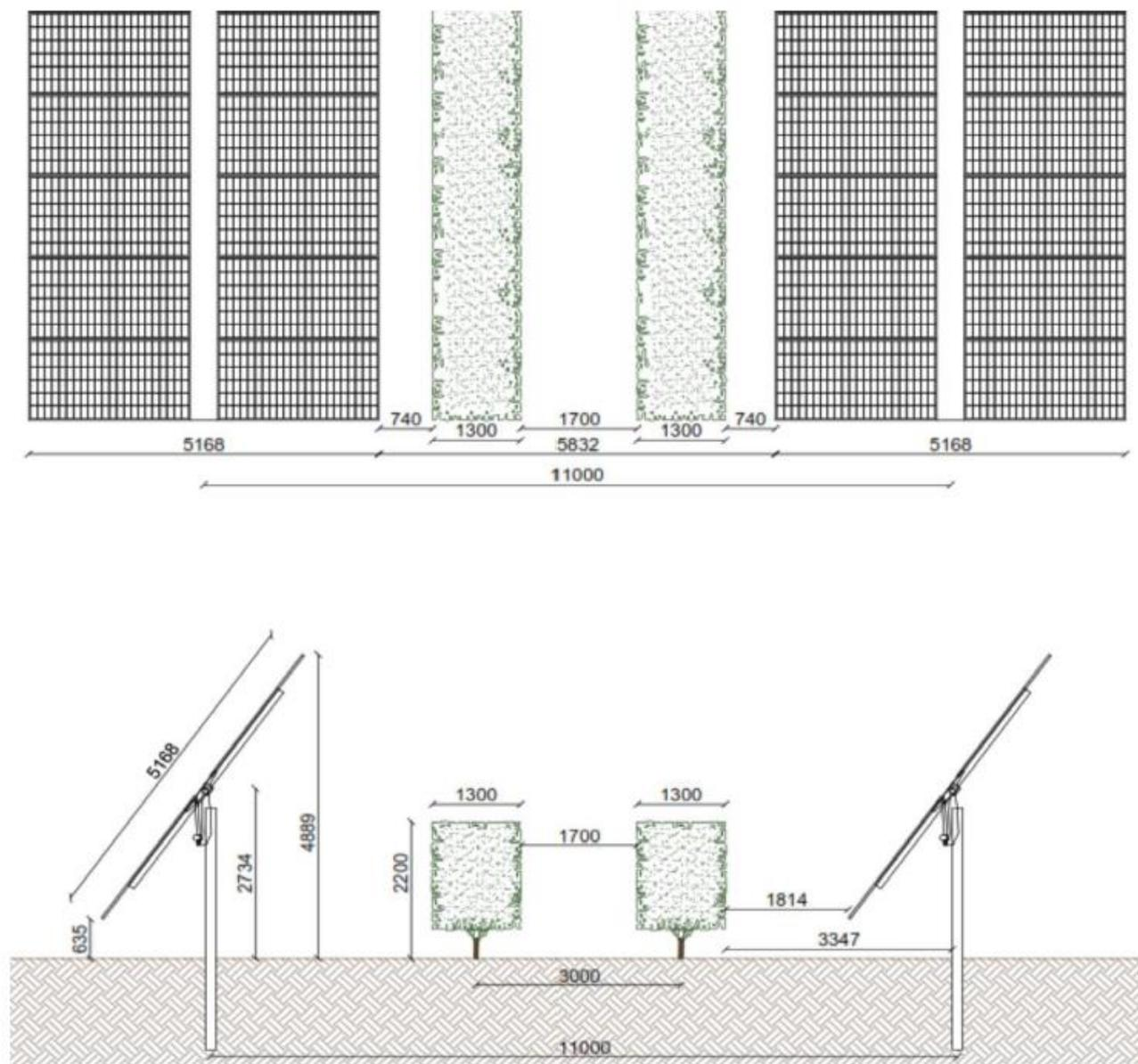
Figura 11 - Layout impianto agri-voltaico
