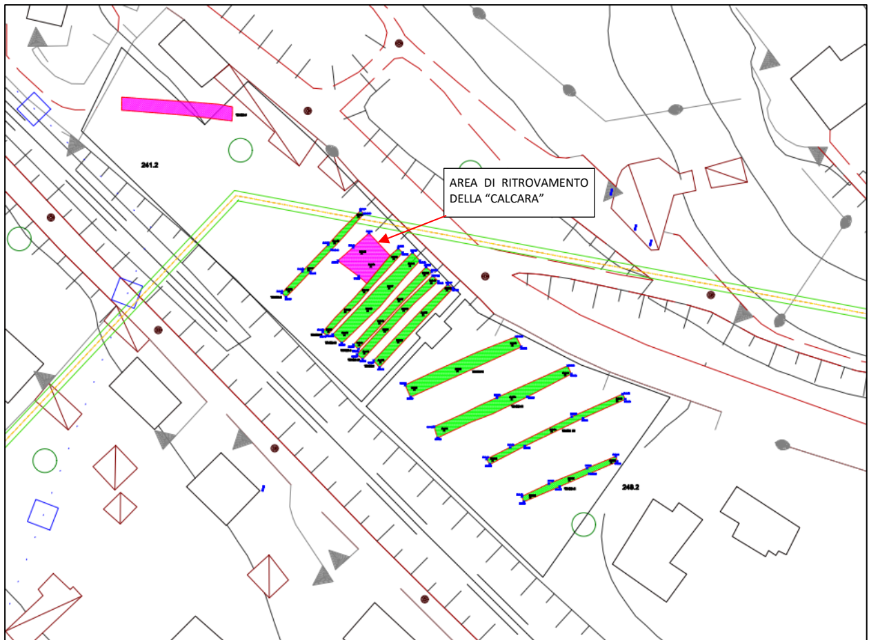
Figura 4.2 - Indagini archeologiche nel sito del cantiere PZ2. In verde i saggi negativi, in rosa i saggi positivi. Nel sito del cantiere PZ2 è stata rinvenuta un'antica fornace da calce detta "calcara", inquadrabile in un arco cronologico tra la tarda età repubblicana e l'età imperiale
