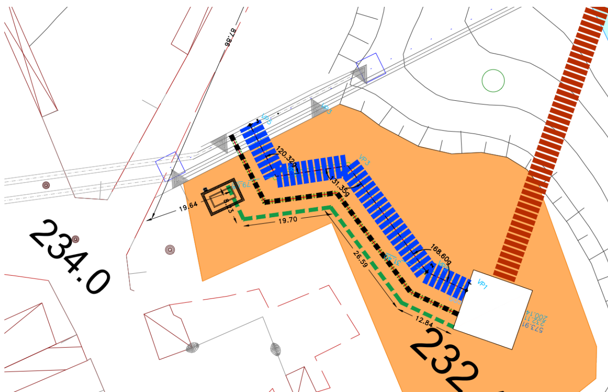
Figura 5.1 – Cabina elettrica interrata MT in corrispondenza dell'area del cantiere PZ4 che viene eliminata nel PE
