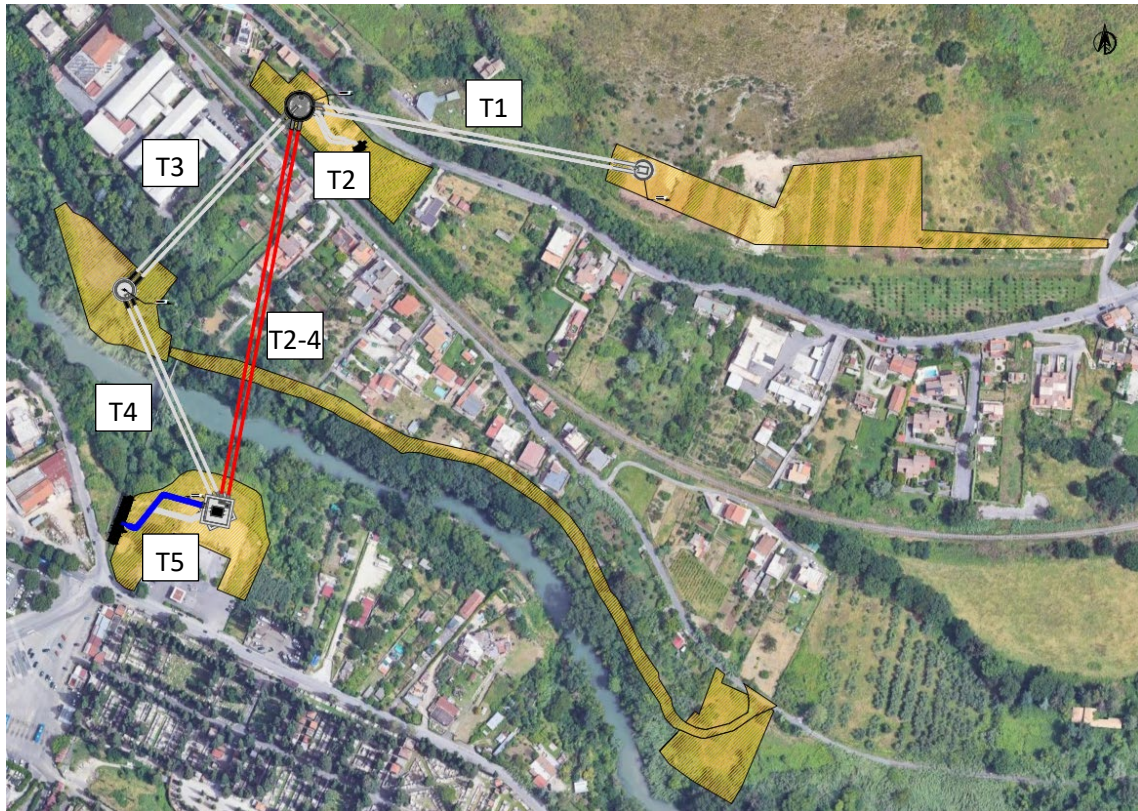
Figura 4.4 – Planimetria di sovrapposizione del progetto base approvato (in colore grigio chiaro) con i relativi cantieri (in colore giallo) e la variante P22-P24 in colore rosso. Sono individuati anche i tratti di condotta sotterranei con la sigla di attribuzione (T1, T2, T3, T4, T5, T2-4). Il nuovo tratto di variante è denominato T2-4
