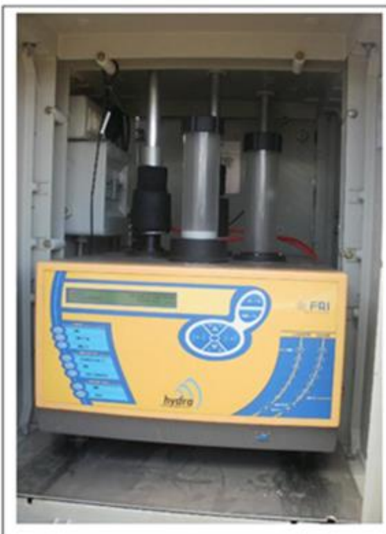
Campionatore sequenziale automatico per PM10 e PM2,5
