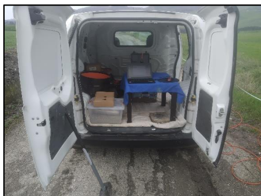
Fotografia 3 -Sismografo PASI modello GEA24
