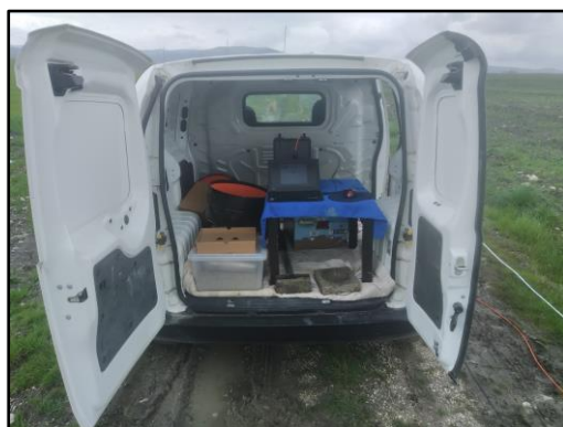
Fotografia 15 -Sismografo PASI modello GEA24
