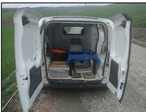
Fotografia 19 -Sismografo PASI modello GEA24
