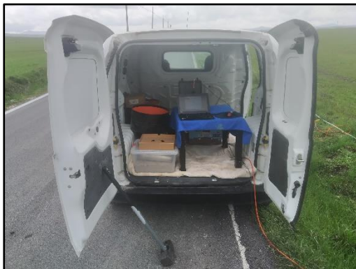
Fotografia 7 -Sismografo PASI modello GEA24
