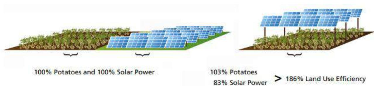
Figura 87: LER rilevato per l'impianto sperimentale di Heggelbach nel 2017 e nel 2018 (Fonte: Trommsdorff M. et al., 2020)
