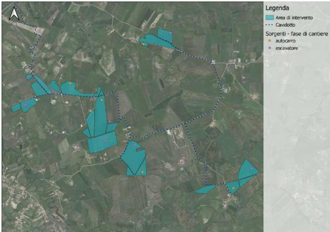
**Figura 133: individuazione delle sorgenti sonore – fase di cantiere**
