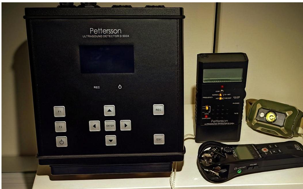
Figura 10 - Attrezzatura utilizzata per il monitoraggio dei chiroterteri. Da destra verso sinistra: Bat detector D 500X per la registrazione prolungata in campo degli ultrasuoni. Rilevatore a eterodina ed espansione temporale (x10 e x20 selezionabile). Registratore multitraccia collegato al D 240X
