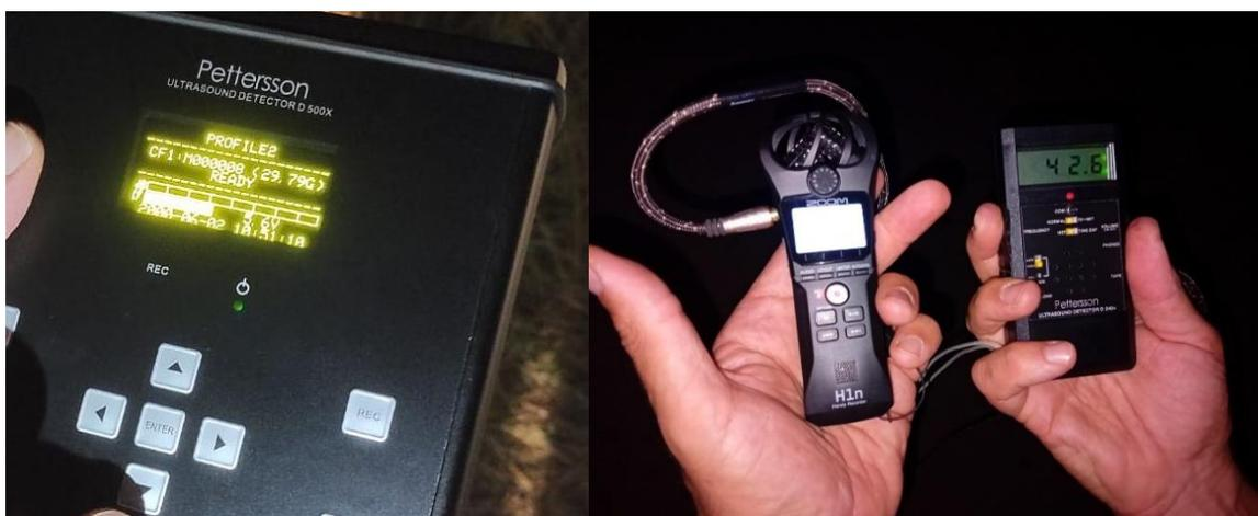
Figura 11 - Preparazione del Bat Detector Petterson D500 x per i rilievi su postazione fissa prolungata e D240 per i punti ascolto
