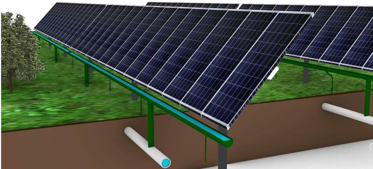
Figura 23 - Sistema per l'accumulo di acqua piovana in un impianto agrovoltaico (fonte: Rain Water Recovery)
