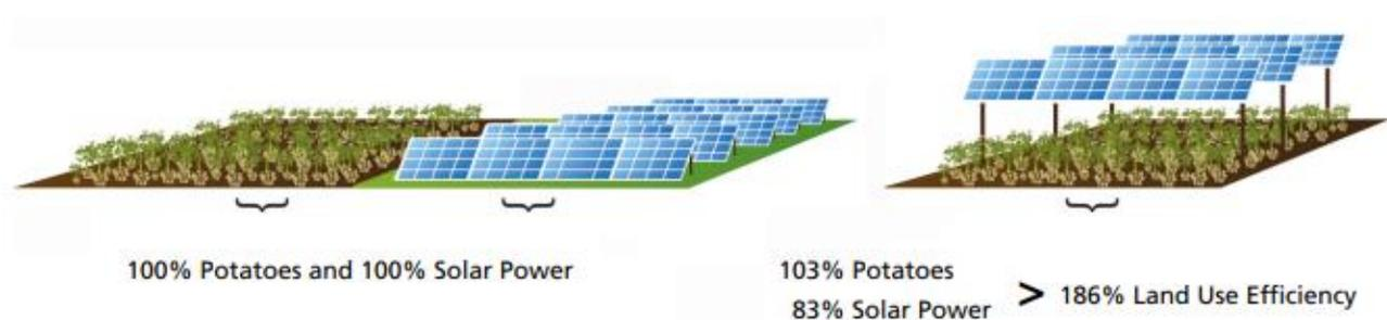
Figura 18: LER rilevato per l'impianto sperimentale di Heggelbach nel 2017 e nel 2018 (Fonte: Trommsdorff M. et al., 2020)
