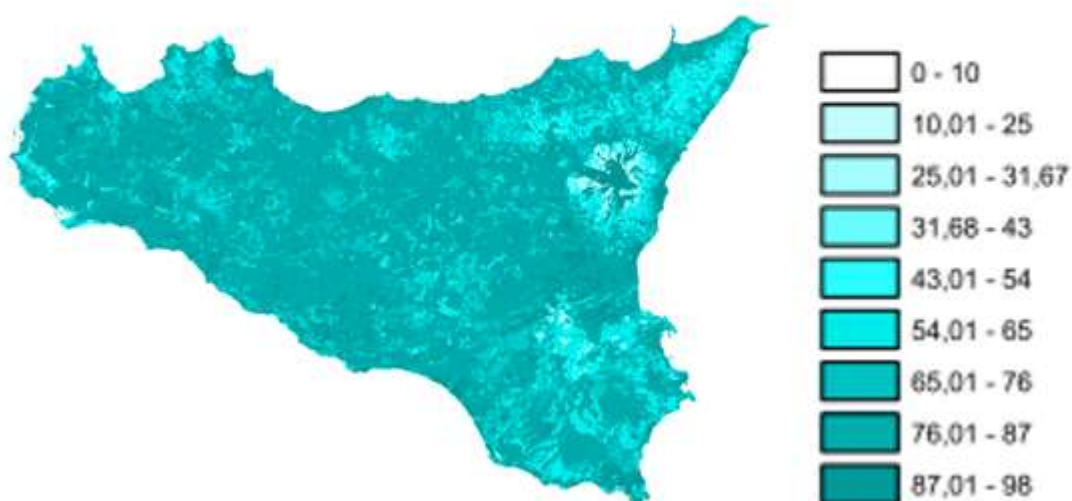
Figura 10: Stralcio della Tav.7 allegata alla Relazione Generale del P.A.I., con griglia areale del coefficiente “CN”
