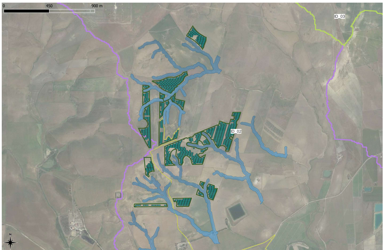
Figura 12: Sovrapposizione dell'ortofoto con i risultati del modello idraulico – Zona 02.
