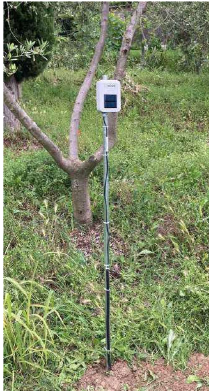
Esempio di installazione di sensore per il rilievo temperatura e umidità del suolo
