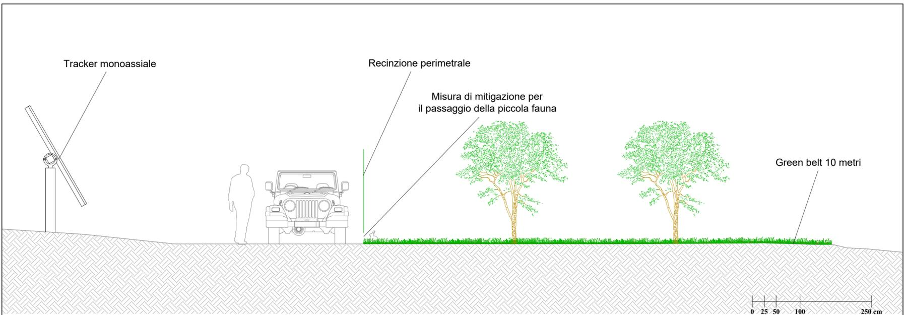
SEZIONE TIPO DELLA RECINZIONE PERIMETRALE - SCALA 1:50
