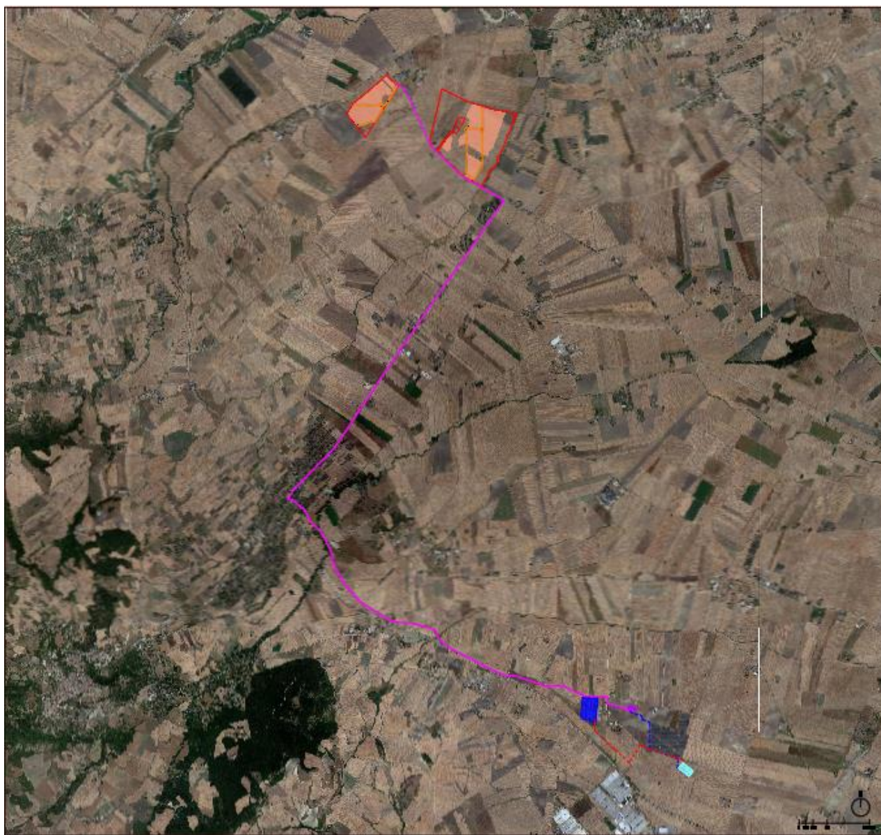
Figura 3: inquadramento territoriale su ortofoto dell'area di impianto; in magenta è stato rappresentato il tracciato delle dorsali a 30 kV di collegamento con la Sottostazione Elettrica di Utenza; in blu il tracciato dell'elettrodotto AT a 150 kV che consente di collegare la Sottostazione Elettrica di Utenza (rettangolo in magenta) con l'ampliamento della Stazione Elettrica di Trasformazione di Deliceto; in ciano l'ampliamento della Stazione Elettrica di Deliceto; in rosso il collegamento in AT tra il satellite (ampliamento) e la Stazione Elettrica 380/150 kV di Deliceto
