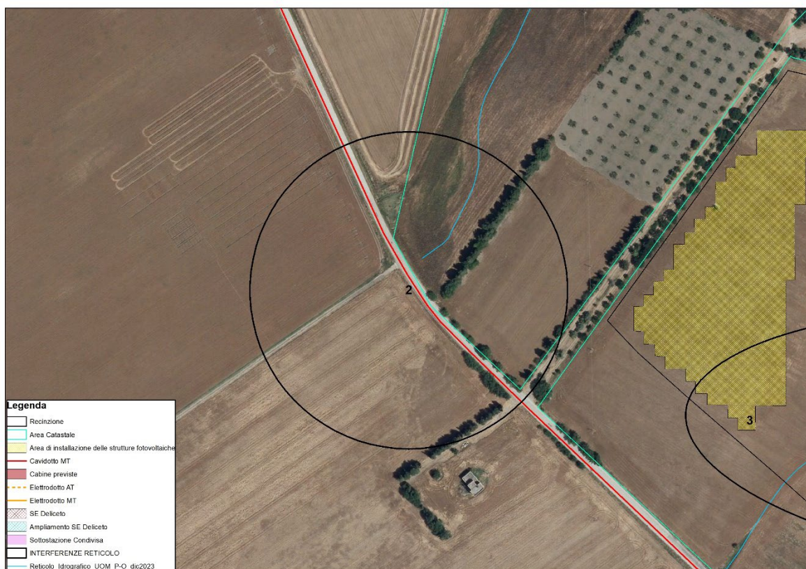
Figura 9: Dettaglio interferenza N.2 con RETICOLO IDROGRAFICO
