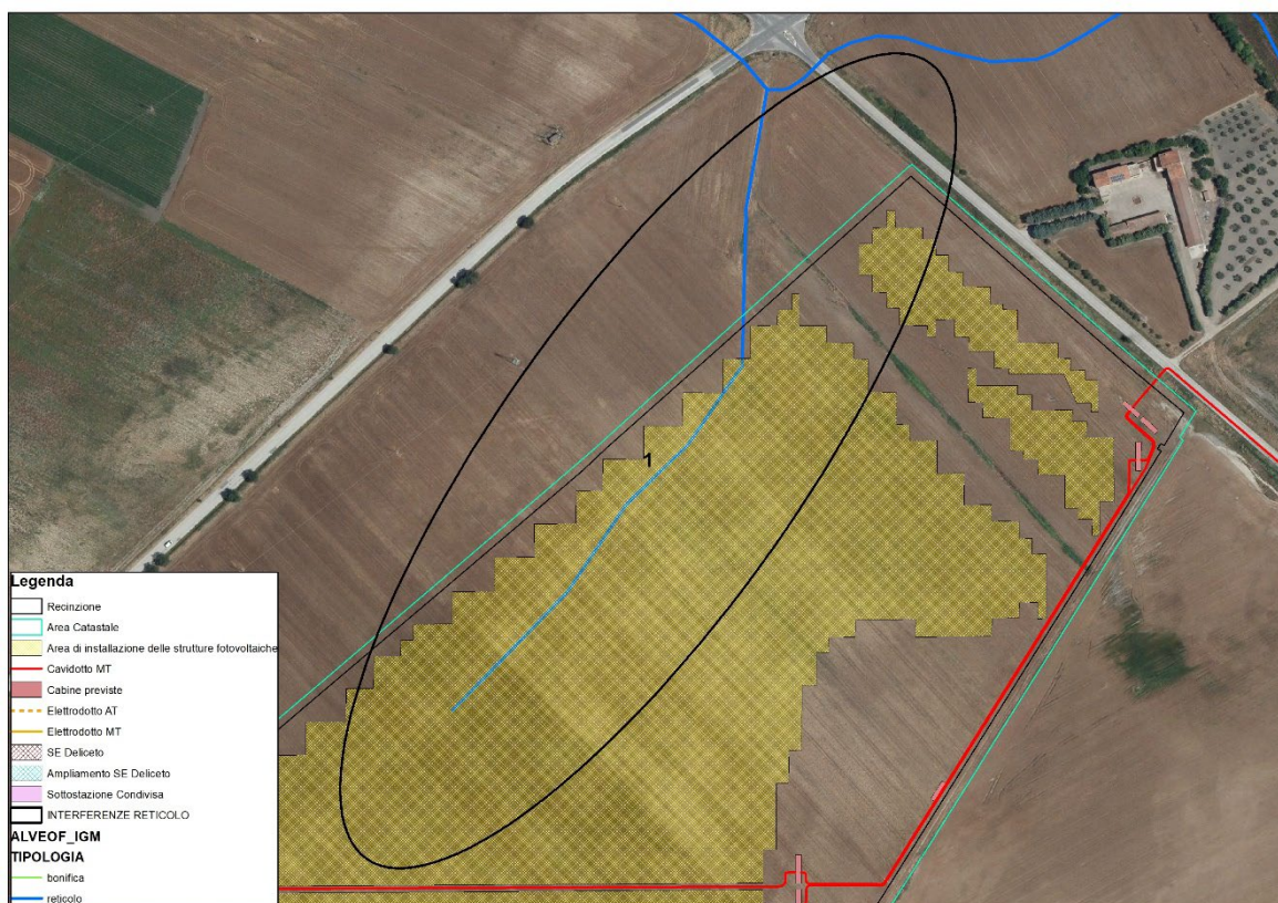
Figura 8: Dettaglio interferenza N.1 con RETICOLO IDROGRAFICO
