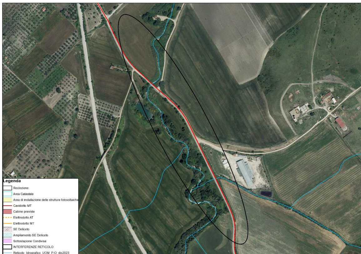
Figura 12: Dettaglio interferenza N.5 con RETICOLO IDROGRAFICO
