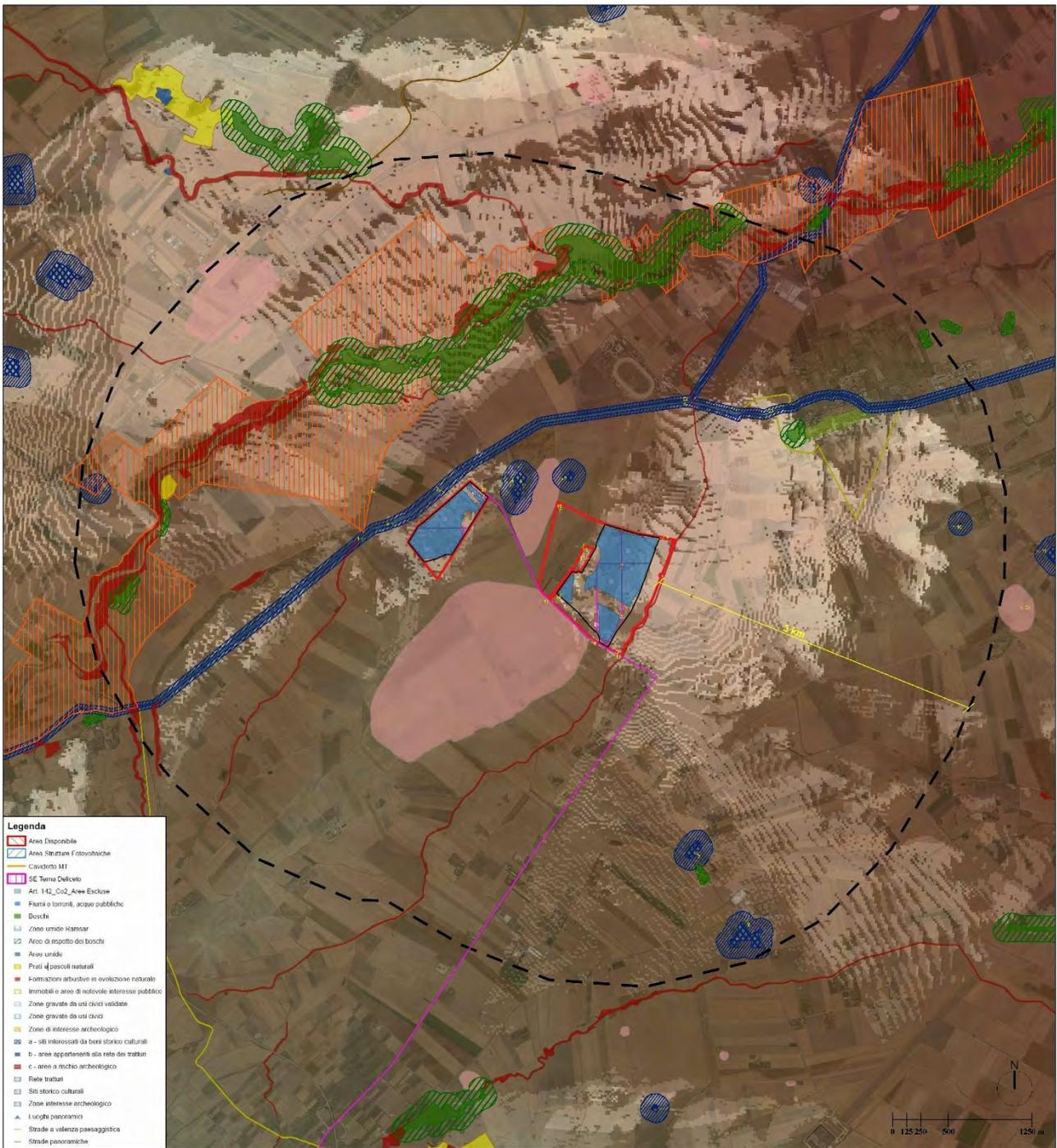
Figura n°1 - Inquadramento della cartografia vincolistica relativa al PTPR della Regione Puglia con indicazione dell'area contrattualizzata (in rosso), del posizionamento delle strutture fotovoltaiche (in celeste), l'indicazione dei punti analizzati (in giallo) e la mappatura dell'intervisibilità del sito all'interno dell'area vasta ricavata attraverso l'interpolazione del DTM con l'areale indagato su software GIS (in bianco)
