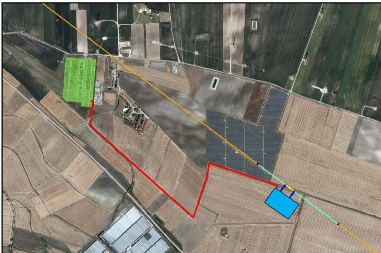
*Figura 7: inquadramento territoriale su ortofoto opere di rete necessarie per la connessione - in verde la Stazione Elettrica di Trasformazione 380/150 kV di Deliceto; in blu i raccordi di collegamento del satellite alla linea elettrica RTN 150 kV Ascoli Satriano – Deliceto; in celeste l'ampliamento della sezione a 150 kV; in rosso l'elettrodotto a 150 kV in cavo interrato a mezzo del quale il satellite verrà collegato con la sezione a 150 kV della SE Deliceto.*
