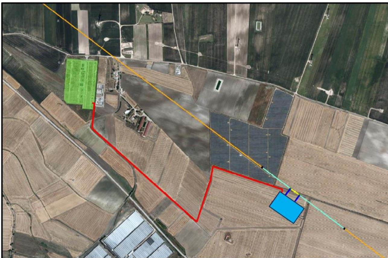
*Figura 9: inquadramento territoriale su ortofoto delle opere di rete necessarie per la connessione- in verde la Stazione Elettrica di Trasformazione esistente; in celeste il nuovo satellite inserito in entra-esce sulla linea RTN Ascoli Satriano-Deliceto a mezzo di due nuovi raccordi aerei (indicati in blu); in rosso l'elettrodotto AT in cavo interrato a mezzo del quale il satellite verrà interconnesso con la SE Deliceto*
