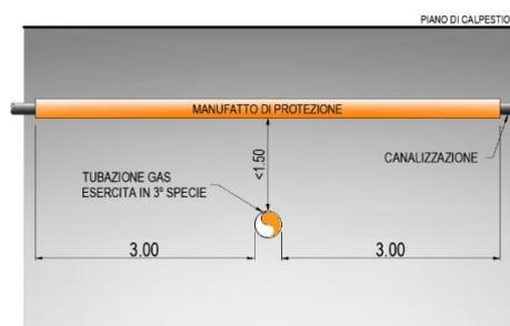
Il manufatto di protezione chiuso drenante dovrà essere realizzato con le modalità indicate dalla UNI/TR 11228 del 2007, tipologia C1/1, con una tubazione in acciaio rivestita in polietilene, come da schema seguente.
