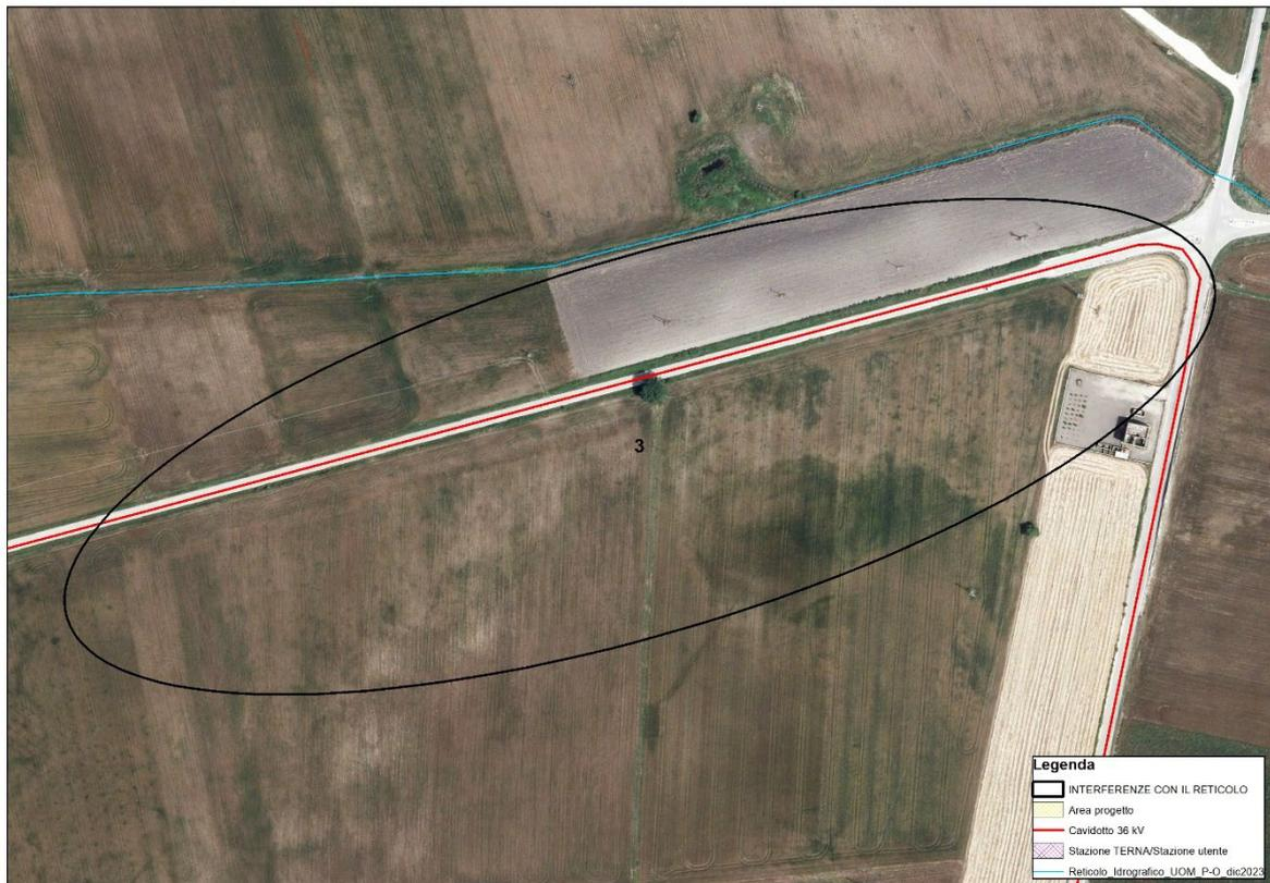
Figura 10: Dettaglio interferenza N.3 con RETICOLO IDROGRAFICO
