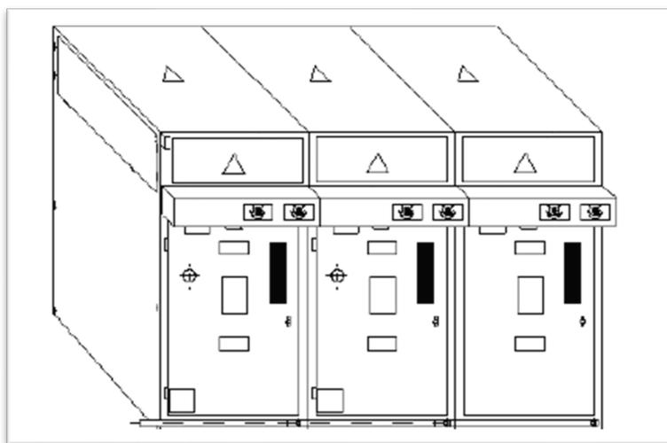
*Figura 16: immagine indicativa quadro elettrico 30 kV isolato in aria*
