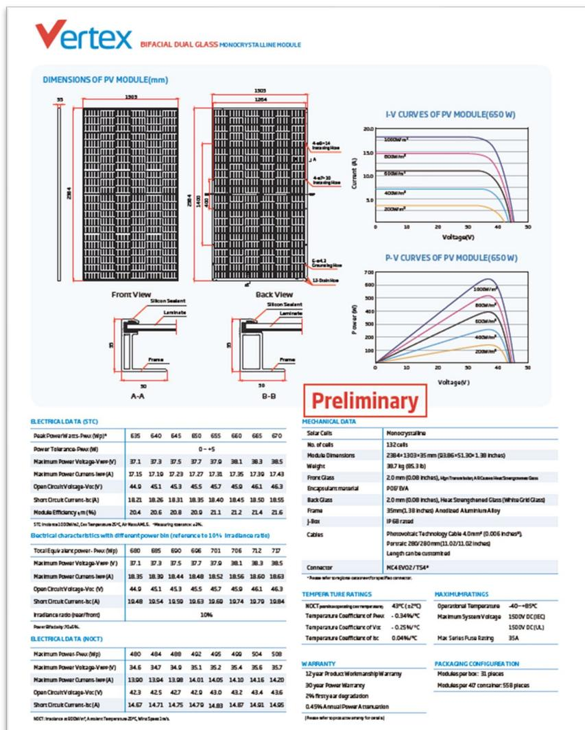
Figura 10: datasheet dei moduli fotovoltaici
