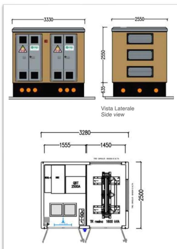
Figura 19: Costruttivo Cabine Servizi Ausiliari
