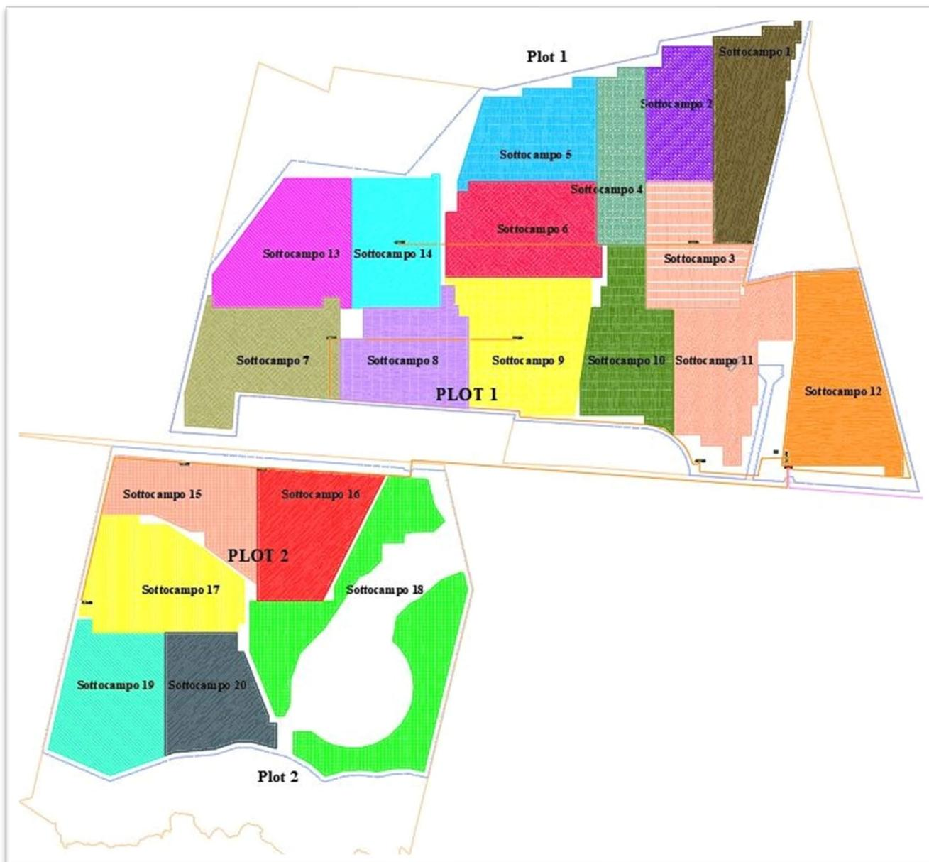
*Figura 9: indicazione dei sottocampi fotovoltaici delle due sezioni di generazione – a sud la suddivisione del Plot 2*
