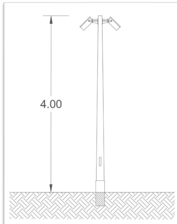
*Figura 20: sostegno per impianto di videosorveglianza*
