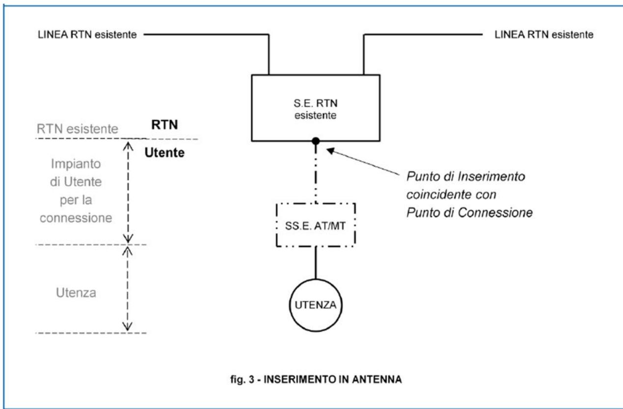
*Figura 2: schema di inserimento in antenna con la sezione a 150 kV di una Stazione Elettrica RTN*
