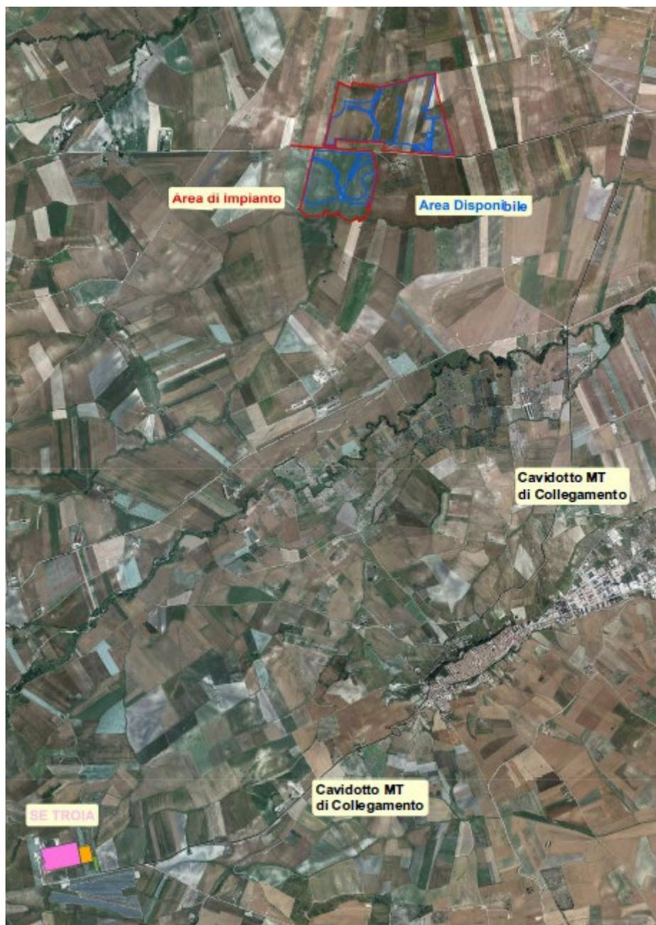
**Figura 3: inquadramento territoriale su ortofoto dell'area di impianto con indicazione del tracciato della dorsale a 30 kV di collegamento con la Sottostazione Elettrica di Utenza MT/AT**
