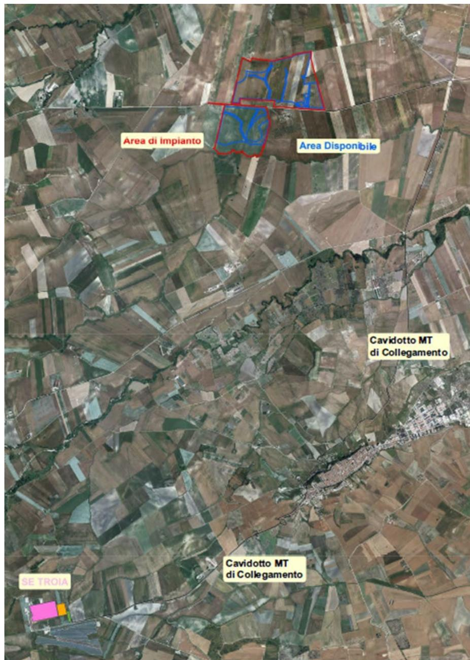
*Figura 7: inquadramento territoriale su ortofoto dell'area di impianto con indicazione del tracciato della dorsale a 30 kV di collegamento con la Sottostazione Elettrica di Utenza*
