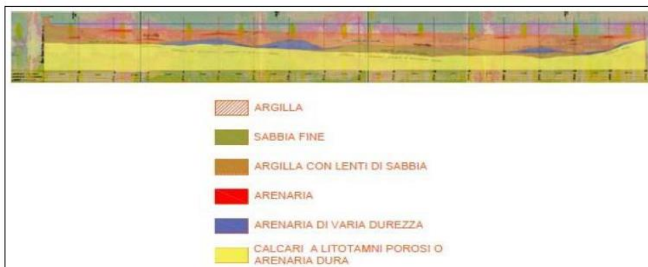
Figura 4-6 – Profilo geognostico Pontile Solidi.
