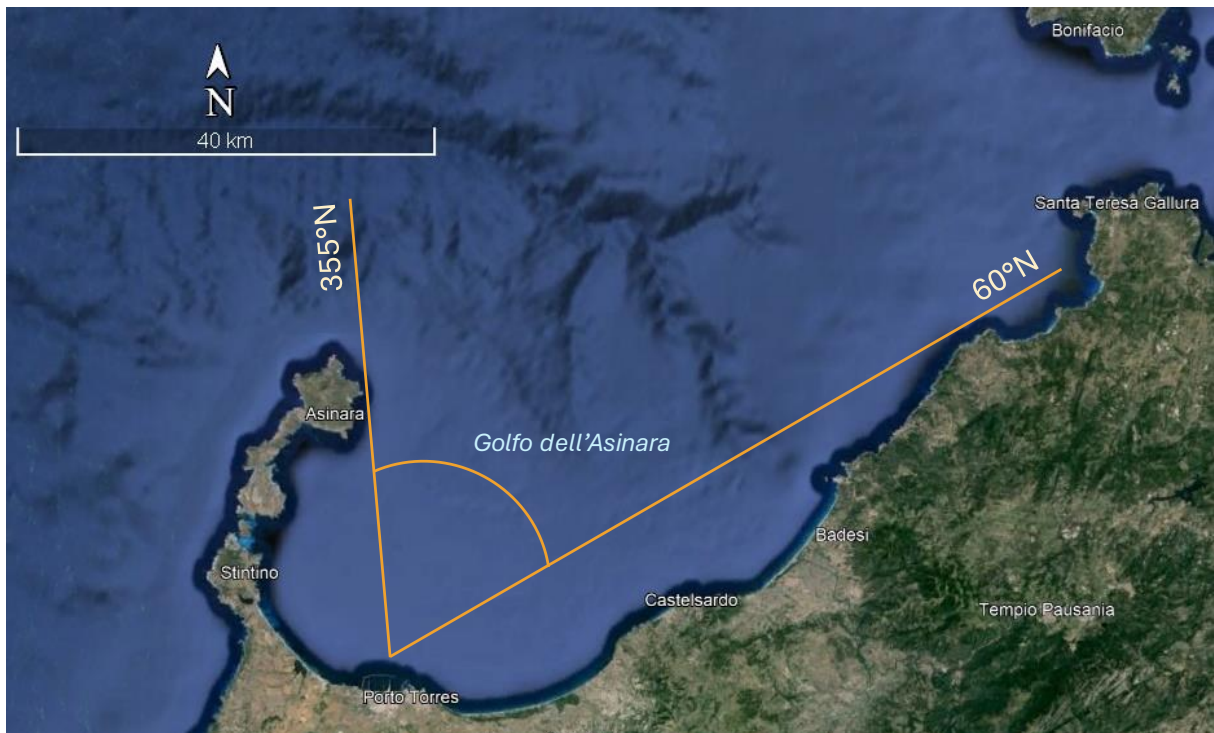
Figura 5-1. Inquadramento geografico del sito di Porto Torres con indicazione del settore di traversia principale.
