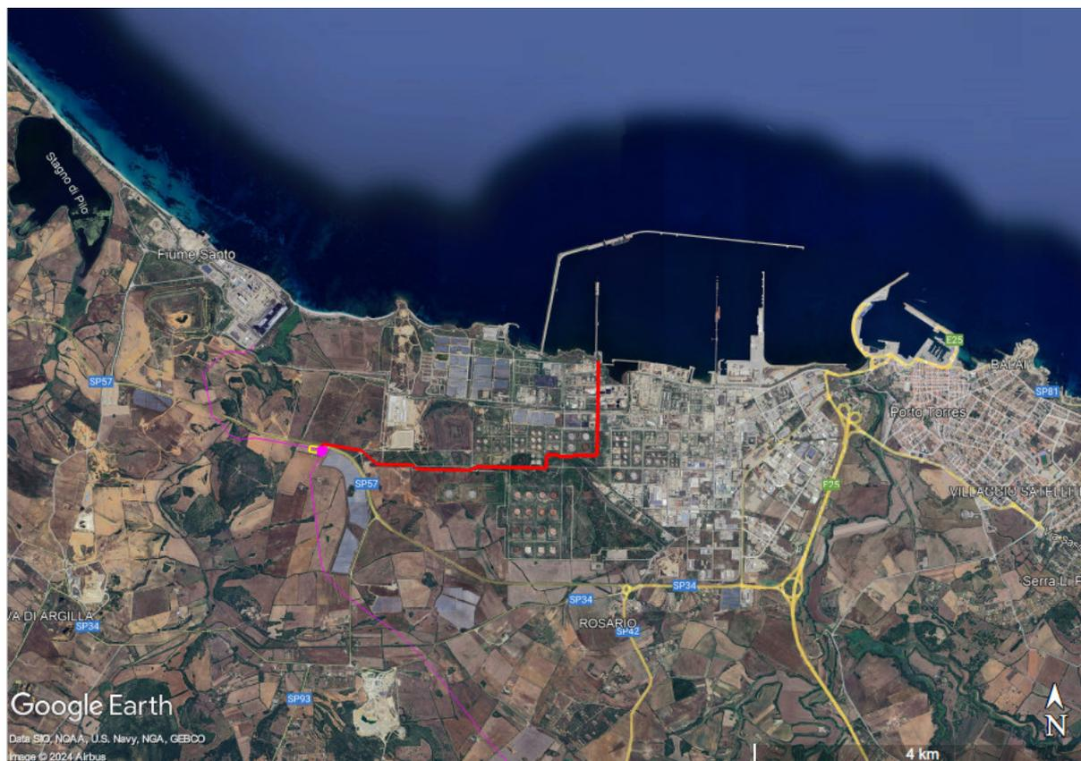
Fig. 3 - dettaglio dell'inquadramento territoriale e sviluppo del nuovo gasdotto in progetto (linea rossa)
