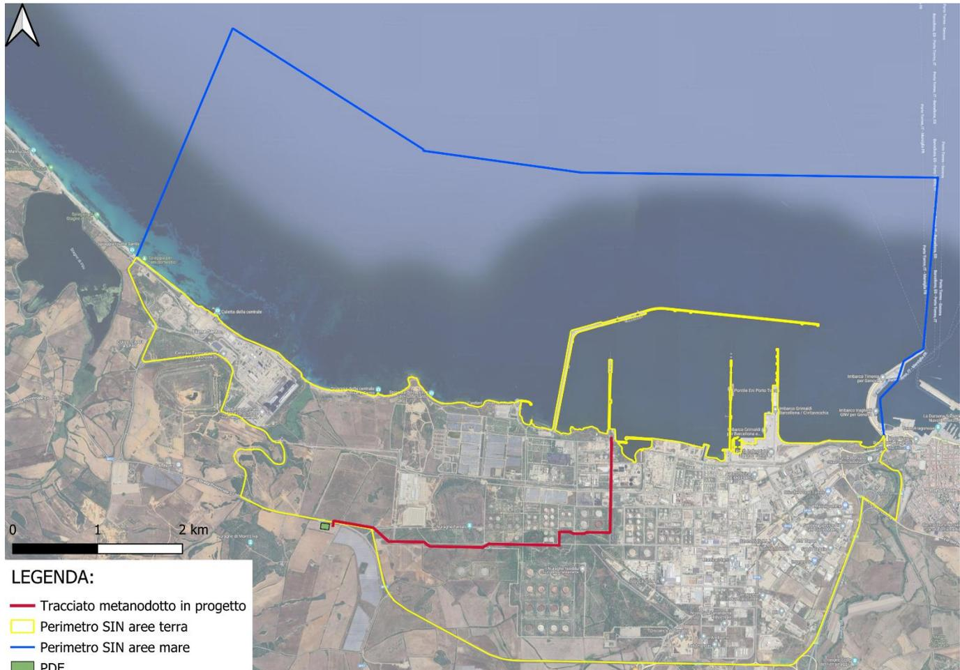
*Figura 3.1: Stralcio immagine aerea con localizzazione dell'area di intervento: in rosso il tracciato di progetto dell'opera, in giallo la perimetrazione del SIN area a terra, e in blu la perimetrazione del SIN area a mare IN SCALA 1:50000*
