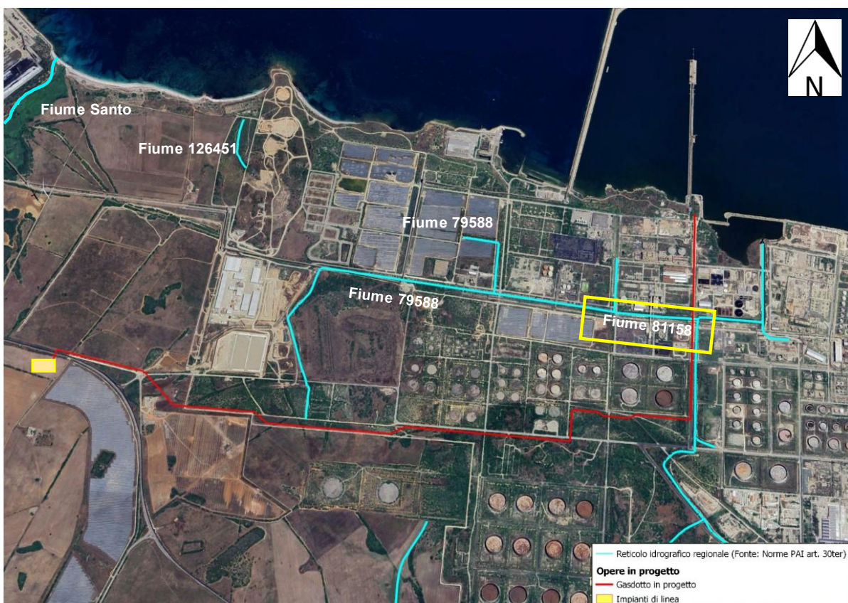
Figura 5.8-3. Corsi d'acqua presenti nell'ambito di studio. Il riquadro in giallo identifica i canali interessati dal progetto (attraversato in trenchless )
