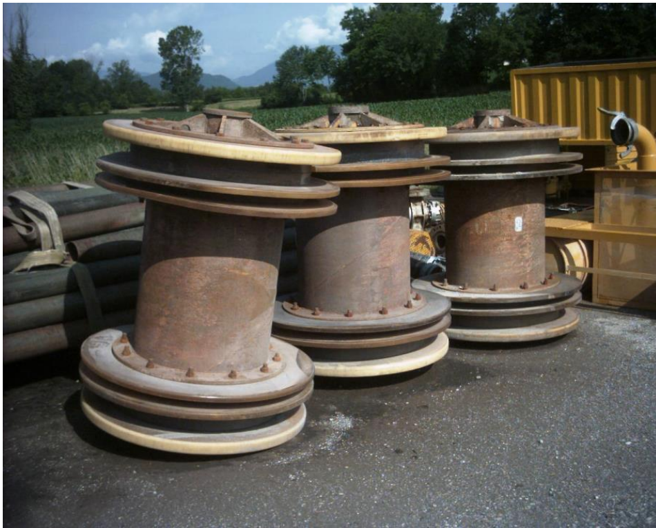
Foto 3.3-2: Pig per collaudo idraulico
