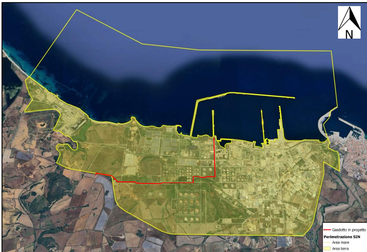
Figura 5.8-6: area inclusa nel Sito di Interesse Nazionale e oggetto del processo di bonifica, con individuazione del tracciato del gasdotto in progetto.
