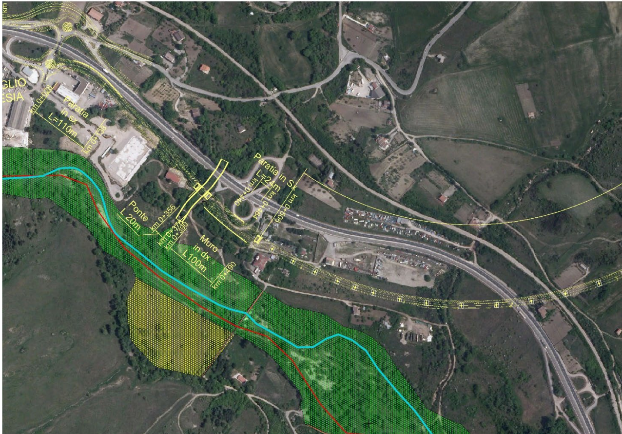
Figura 3.1 – P.G.R.A.-A.B. Basilicata – Estratto Mappa del rischio alluvioni – tav. 20D con sovrapp. progetto
