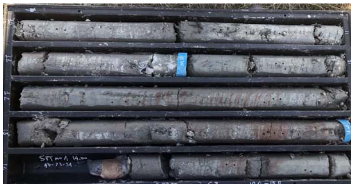
Foto 2-9 – Esempi in affioramento (Vallone Tricarico – Alt. 2) e da carotaggio del Gruppo delle Argille Varicolori
