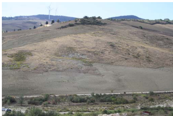
Foto 3-9 – Testimonianze dei processi di creep e dissesti superficiali in atto nell'areale di progetto considerato.
