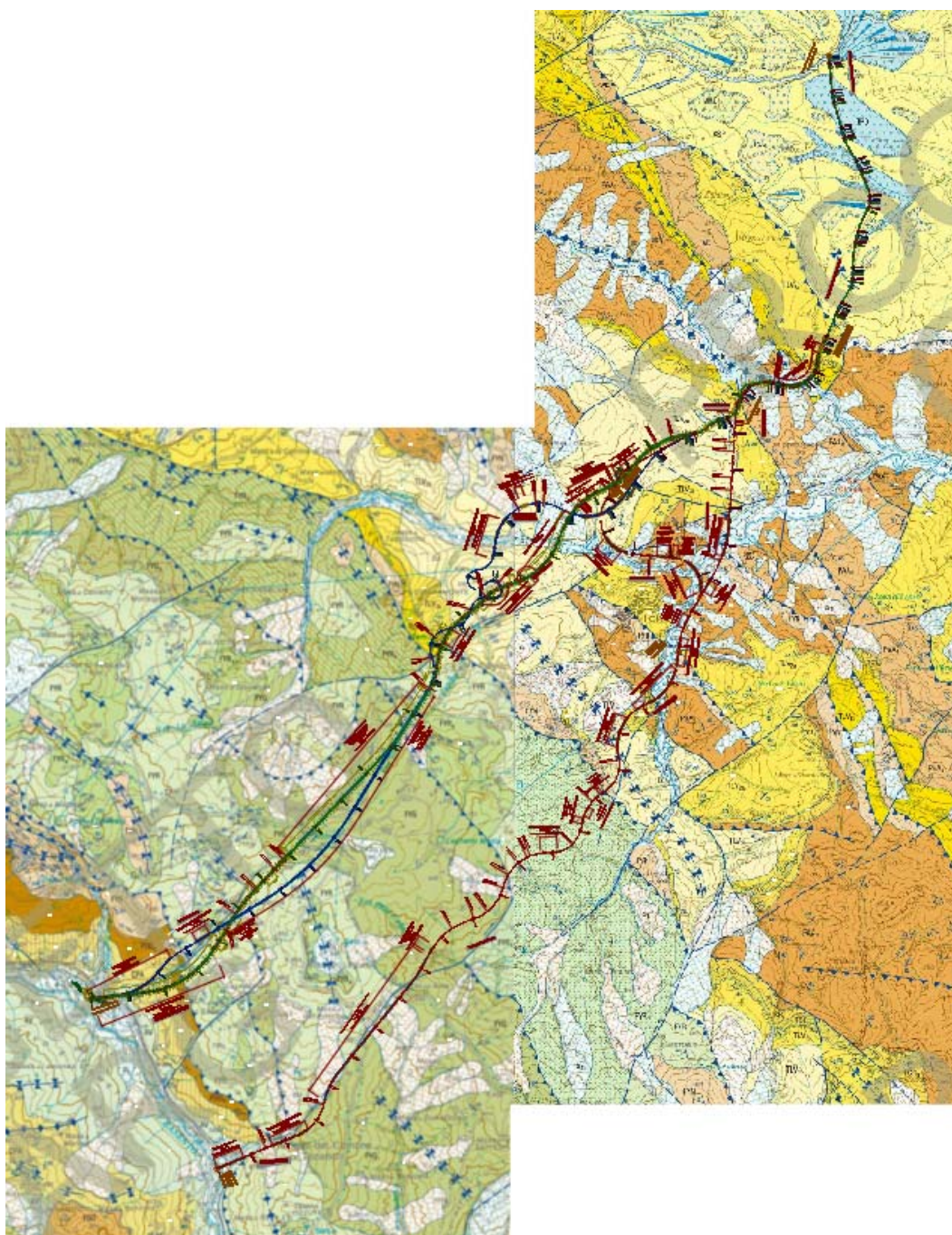
Figura 2-3 - Stralcio cartografia geologica ufficiale CARG dell'ISPRA, ottenuto dall'unione dei fogli 470 "Potenza" e 471 "Irsina", con riportate le alternative di tracciato oggetto di studio.
