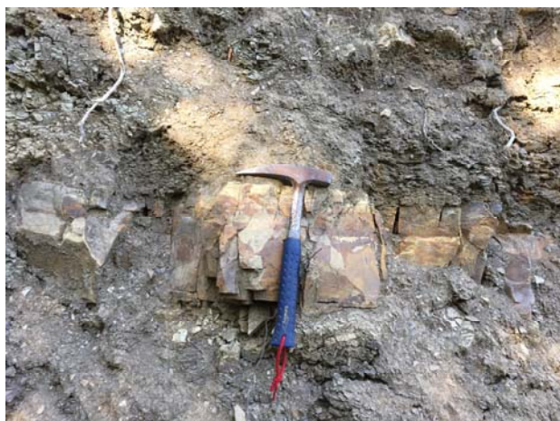
Foto 2-12 – Affioramento del Flysch del Galestrino (FYG) visibile lungo il Vallone degli Zingari ed interferente con l'Alternativa 1
