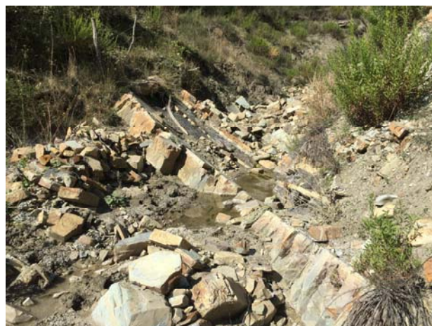
Foto 2-12 – Affioramento del Flysch del Galestrino (FYG) visibile lungo il Vallone degli Zingari ed interferente con l'Alternativa 1
