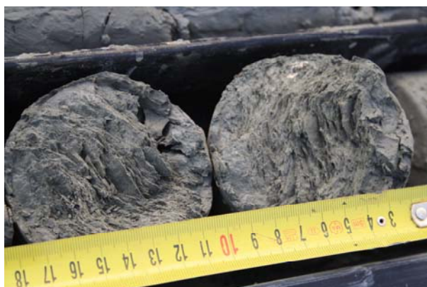
Foto 2-5 – Evidenze delle facies TLV2a (a dx) e TLV2b (a sx) riscontrate durante il rilevamento geologico e le fasi di carotaggio.
