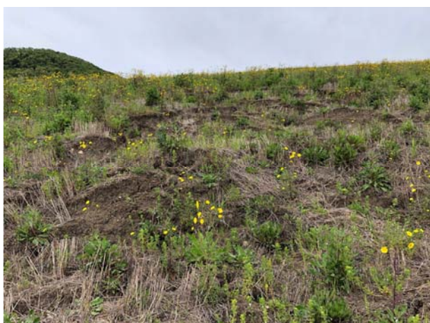
Foto 3-12 – Dettaglio dell'area in frana tra le p.k. 7+177 – 7+190 con di gradini morfologici di neoformazione
