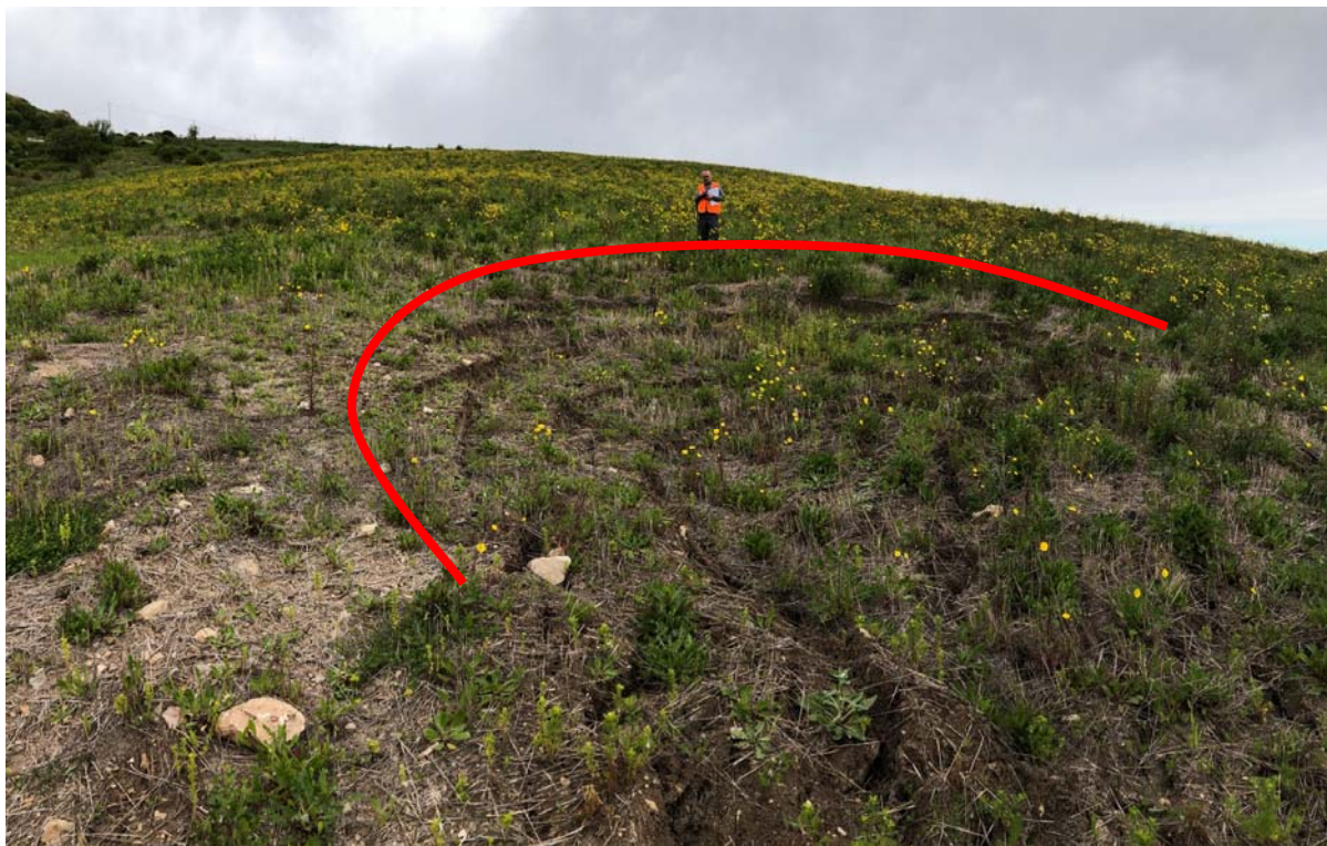
Foto 3-11 – Porzione della area in frana tra le p.k. 7+160 – 7+230 con formazione di scarpate secondarie e frattura in contropendenza.
