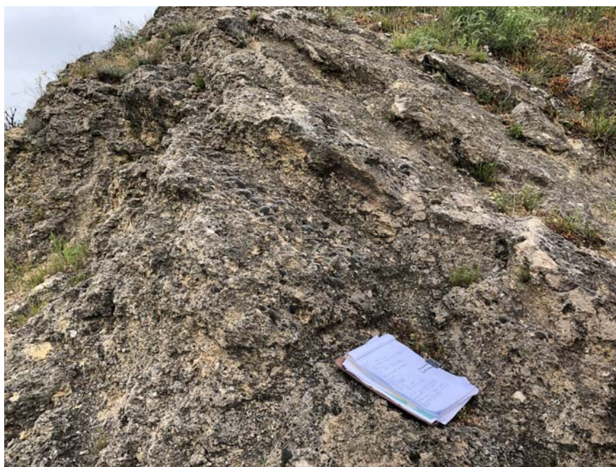
Figura 2-2 – Porzione in affioramento ascrivibile alla litofacies conglomeratica del Subsistema di Potenza TLV1a, posto in prossimità del Viadotto Cerro (Alt.3.1).
